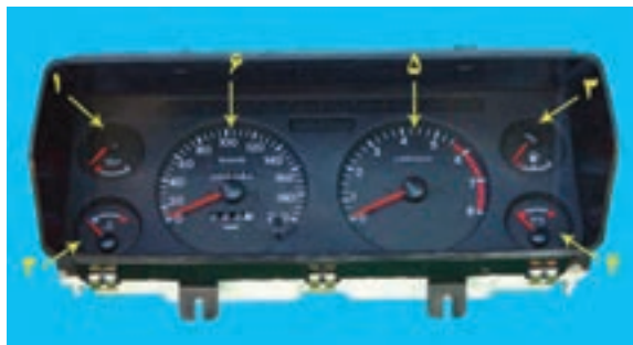
مجموعه نشان دهنده ها: ۱- درجه فشار روغن ۲- درجه دمای آب ۳- درجه بنزین ۴- درجه شارژ باتری ۵- دورسنج موتور ۶- صفحه کیلومتر شمار و سرعت سنج
