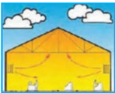
تصویر ۱-۲- مقایسه‌ی سیستم‌های گرمایشی جابه‌جایی و تابشی
