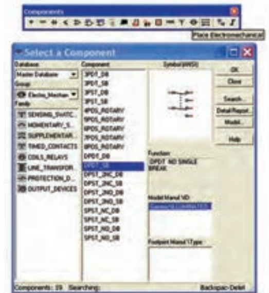
شکل ۲-۶ مسیر دسترسی به کلید باند ( کلید تبدیل)
