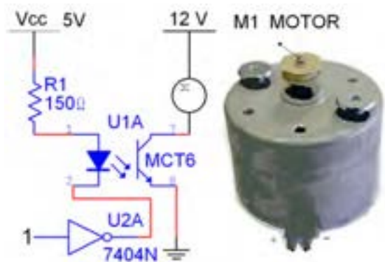
شکل ۷-۲۰ کاربرد جداساز نوری برای راه‌اندازی یک مصرف کننده پر وات
