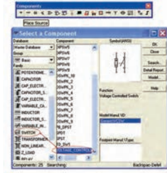
شکل ۱۵-۶ مسیر انتخاب کلید تابع ولتاژ
