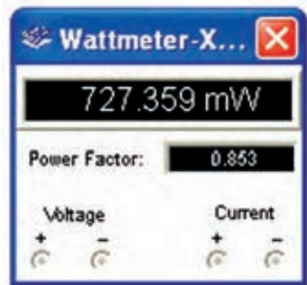
شکل ۳-۵ اندازه‌گیری توان مدار RLC سری
