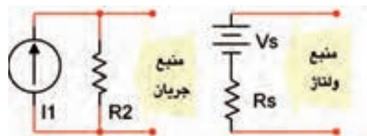
شکل ۱-۱۷ تبدیل منبع ولتاژ به منبع جریان
