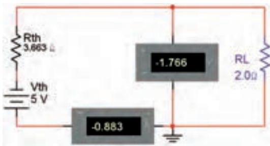
شکل ۲۵-۱ اندازه‌گیری جریان بار با استفاده از مدار معادل تونن
