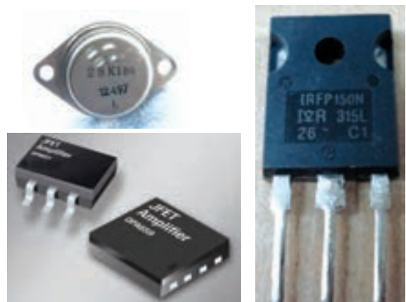
شکل ۳-۸۳- ساختمان ظاهری چند نمونه FET
