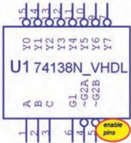
شکل ۲۴-۳ آی‌سی ۷۴۱۳۸ یک رمزگشای ۳ به ۸
