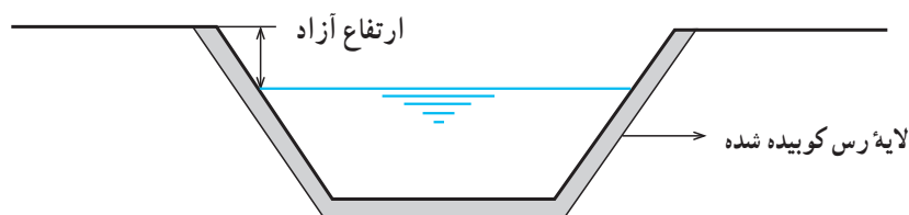
شکل ۱۶-۲- مقطع یک کانال با پوشش خاک رس
