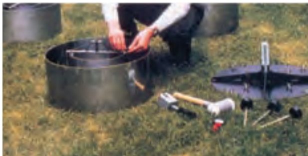
شکل ۳۰-۱ نحوه کار گذاشتن استوانه مضاعف
