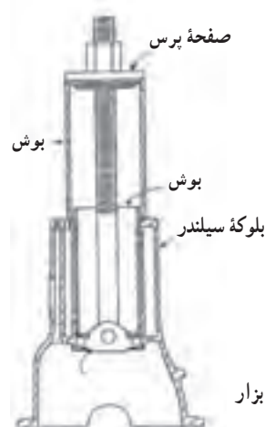
شکل ۱۴۳-۴- نحوه پیاده کردن بوش سیلندر
