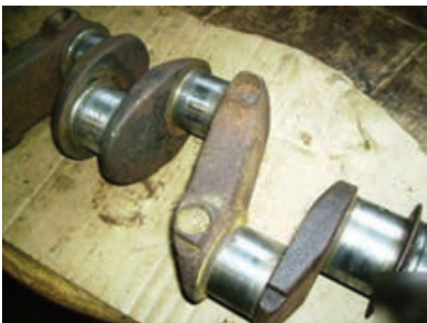
شکل ۲۱۰-۴- میل‌لنگ با رسوبات کربن
