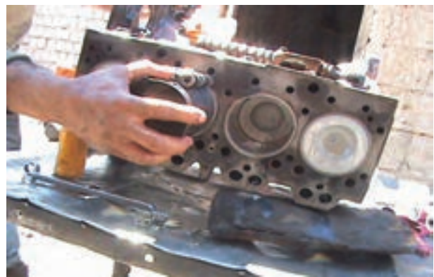
شکل ۱۹۹-۴- چسباندن رینگ جمع کن به سیلندر
