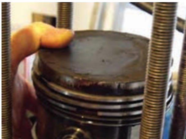
شکل ۲۰۷-۴- رسوبات کربن روی سطح پیستون
