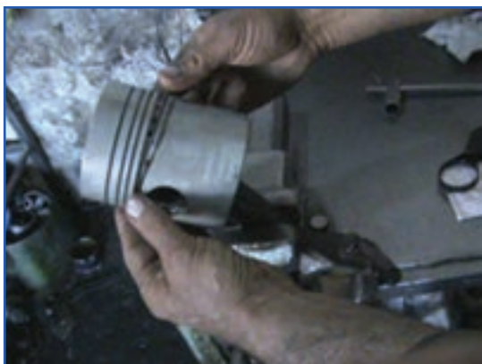
شکل ۱۳۸-۴- جا زدن رینگ با دست
