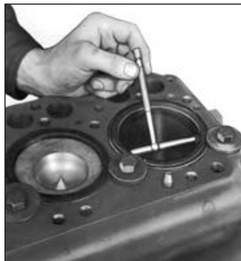
شکل ۱۴۶-۴- اندازه گیری قطر داخلی بوش بعد از جا زدن آن
