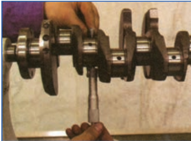
شکل ۱۶۲-۴- اندازه‌گیری قطر محورهای میل‌لنگ
