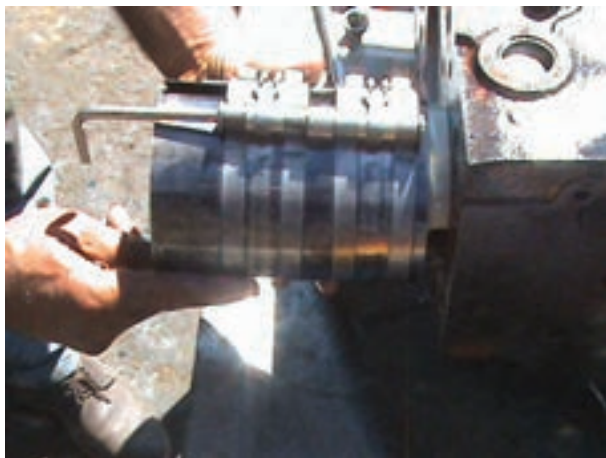
شکل ۱۹۸-۴- جمع کردن رینگها با رینگ جمع کن
