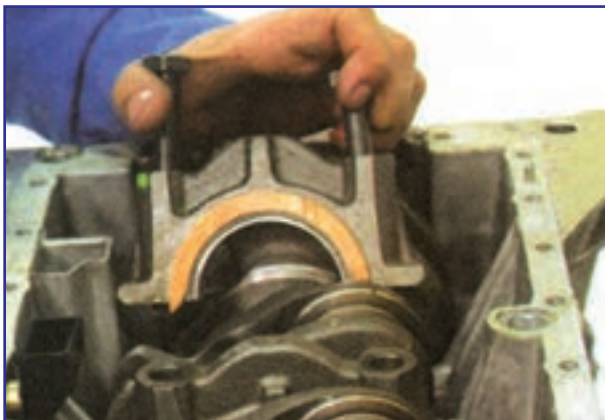
شکل ۱۸۱-۴- برداشتن کپه یاتاقان دارای بغل یاتاقانی
