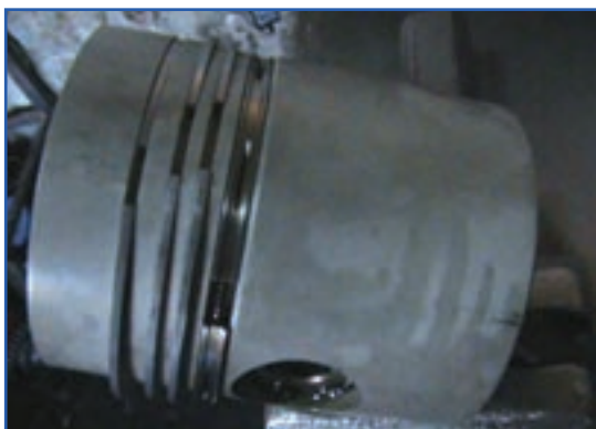
شکل ۱۳۹-۴- ترتیب قرار گرفتن رینگ‌ها روی شیار پیستون
