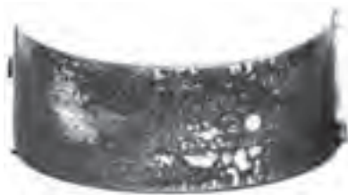
شکل ۱۶۸-۴ اثرات سوختگی روی یاتاقان
