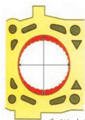
شکل ۱۴۹-۴- وضعیت بیضی شدن سیلندر
