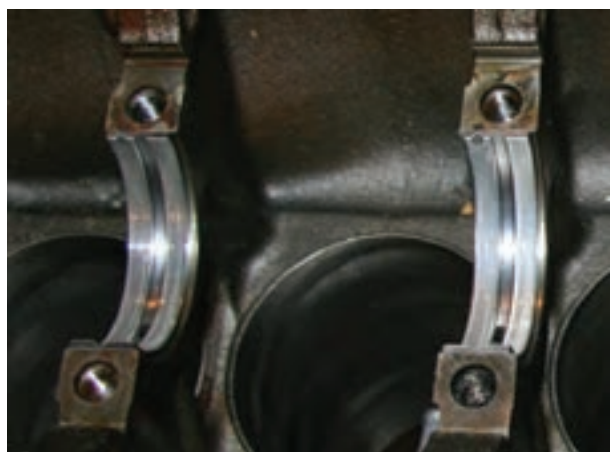
شکل ۱۸۵-۴ جازدن یاتاقان‌های ثابت
