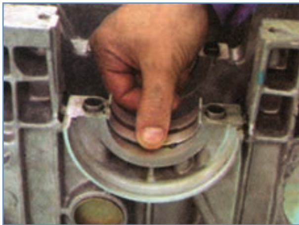
شکل ۱۵۶-۴- خارج کردن یاتاقان‌های ثابت از روی تکیه‌گاه میل لنگ
