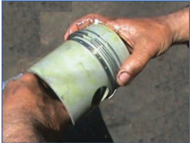
شکل ۱۹۶-۴- تنظیم کردن دهانه رینگها
