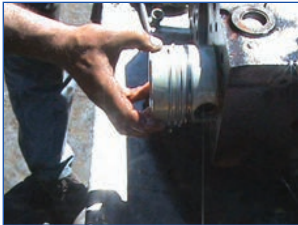
شکل ۱۹۷-۴- قرار دادن پیستون در سیلندر
