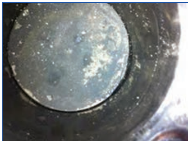
شکل ۲۰۶-۴- رسوبات کربن روی سطح پیستون
