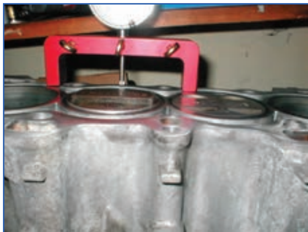
شکل ۲۰۵-۴- کنترل ارتفاع پیستون
