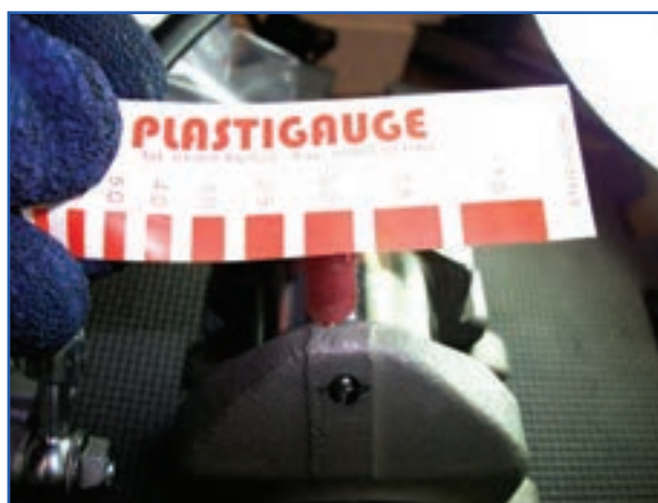
شکل ۱۷۶-۴- اندازه‌گیری دو بهنی پلاستی گیج شابلون
