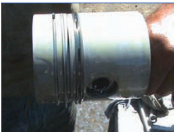
شکل ۱۴۰-۴- روغن‌کاری همه رینگ‌ها و پیستون
