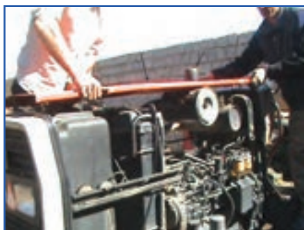
ج) برداشتن پوشش بالای موتور
