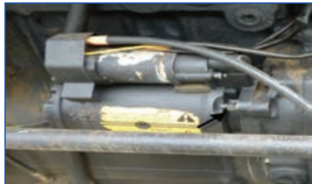
شکل ۳-۸- پیچ های نگهدارنده استارت تر تراکتور MF285
