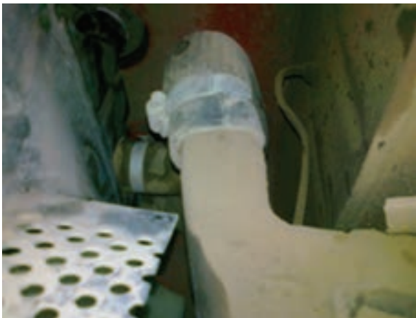
شکل ۱۵-۳- اتصال شیلنگ رادیاتور
