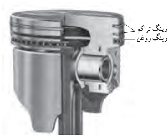
شکل ۲۲-۲- انواع رینگ روی پیستون
