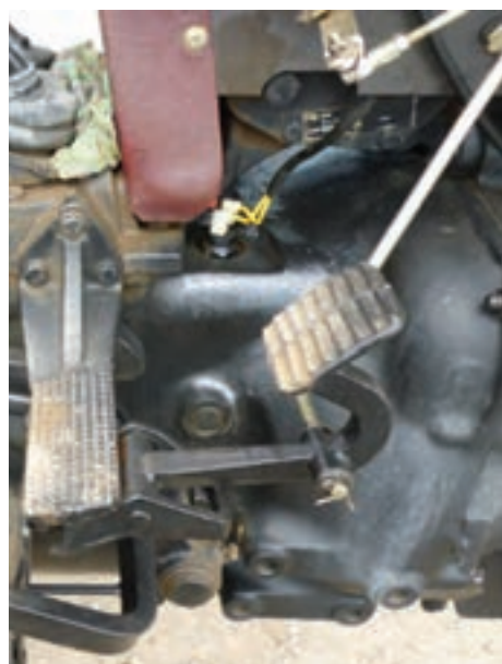
شکل ۱۱-۳- پیچ‌های اتصال موتور به جعبه‌دنده قسمت پایین
