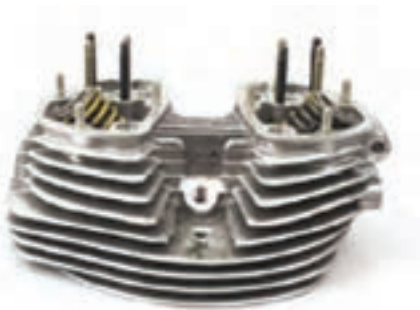
شکل ۳-۲ - سرسیلندر موتور هوا خنک
