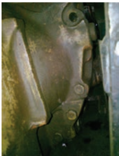
شکل ۱۱-۳- پیچ‌های اتصال موتور به جعبه‌دنده قسمت پایین
