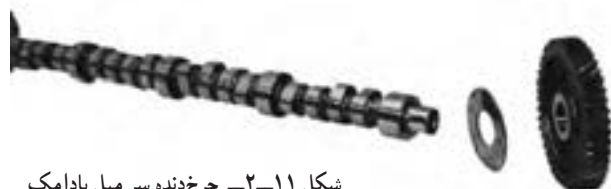
شکل ۱۱-۲ - چرخ‌دنده سر میل بادامک
