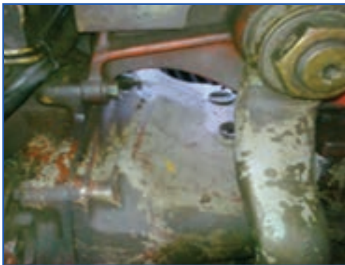
شکل ۹-۳- پیچ‌های اتصال موتور به جعبه‌دنده قسمت بالا
