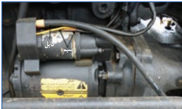
ب) سیم و کابل متصل به استارت تر
