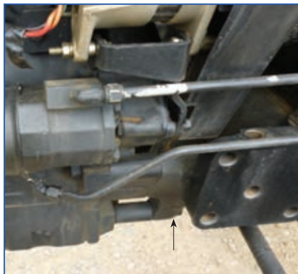
شکل ۱۷-۳- محل پیچ‌های اتصال موتور به جلوی تراکتور
