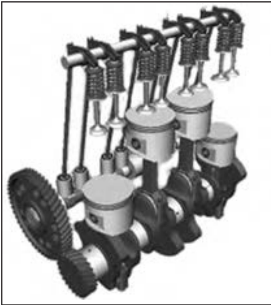
شکل ۸-۲ - قطعات مکانیزم باز و بسته شدن سوپاپها
