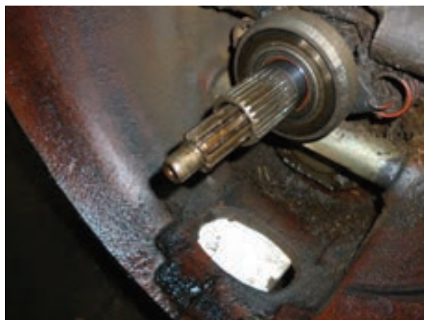
شکل ۱۳-۳- شافت ورودی جعبه‌دنده
