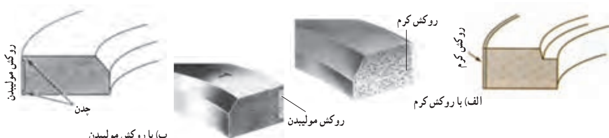
شکل ۲۴-۲- مقطع رینگ‌های تراکم روکش‌دار
