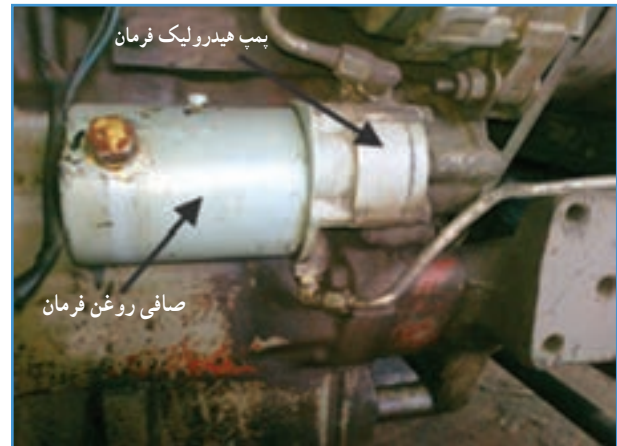
شکل ۲۳-۲- پمپ هیدرولیک فرمان و صافی تراکتور MF285
