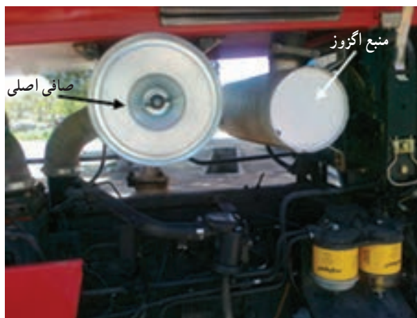
شکل ۲۶-۲- صافی اصلی تراکتور MF399
