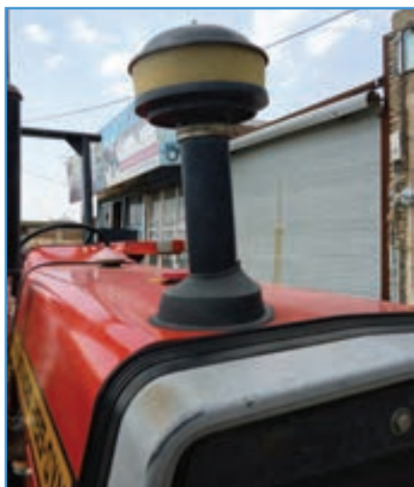
شکل ۲۵-۲- پیش صافی تراکتور MF285
