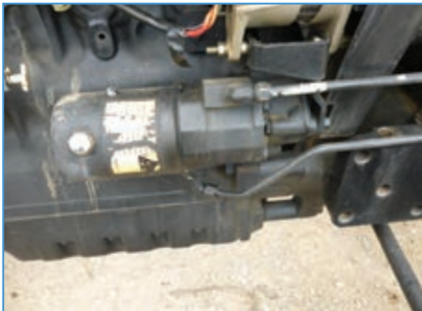
شکل ۲۳-۲- پمپ هیدرولیک فرمان و صافی تراکتور MF285
