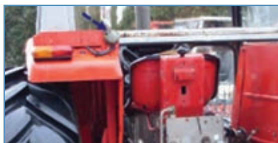
شکل ۱۶-۲- چراغ راهنمای تراکتور MF285
