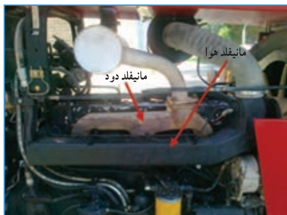
شکل ۲۷-۲- مانیفلد هوا و دود تراکتور MF399
