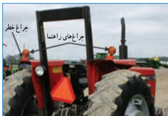
شکل ۱۶-۲- چراغ راهنمای تراکتور MF285
