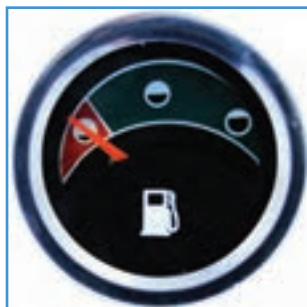
شکل ۹-۲- درجه نشان‌دهنده مقدار سوخت در مخزن سوخت
