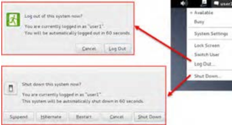
شکل ۳-۱۰- راه اندازی مجدد و خاموش کردن سیستم
