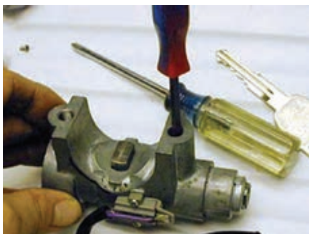
شکل ۱۸-۱۱- باز کردن پیچ مغزی سوئیچ
