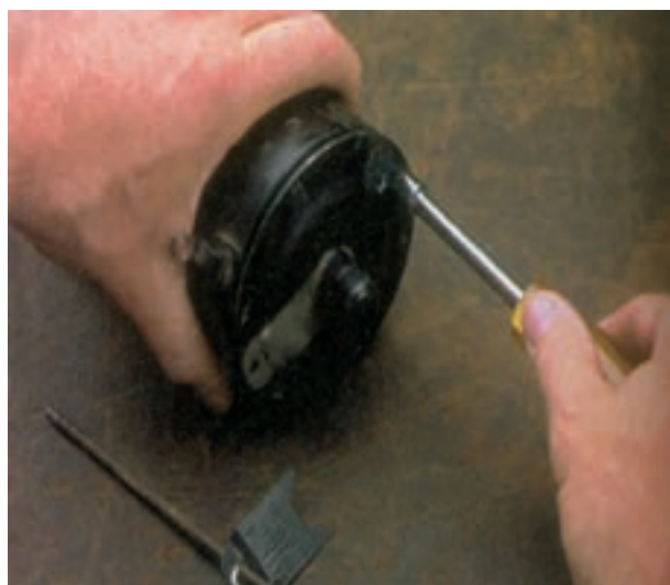
شکل ۸-۵۵ - باز کردن پیچ‌های اتصال درپوش به بدنه
