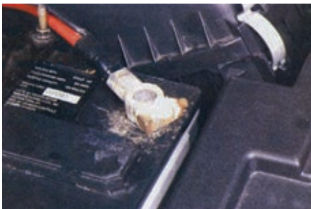
شکل ۳۱-۸ سولفات‌شدن اتصال قطب باتری
