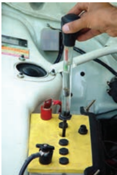
شکل ۸-۲۸- بررسی دشارژ باتری
