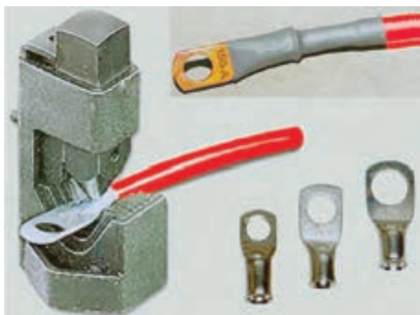
شکل ۸۰-۸- اتصال بست به کابل باتری
