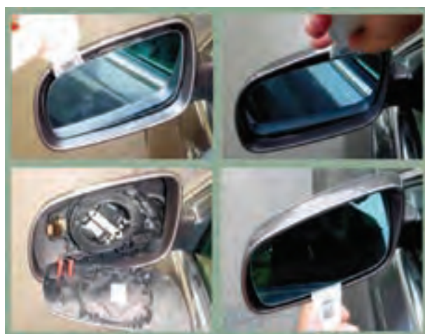
شکل ۱۶۷-۲- بیرون آوردن آینه از داخل قاب آن
