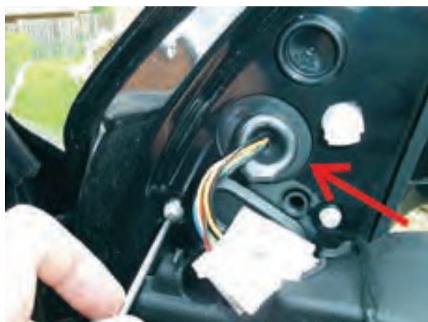
شکل ۲-۱۷۸- بازکردن پیچ نگه دارنده‌ی پایه‌ی اصلی آینه
