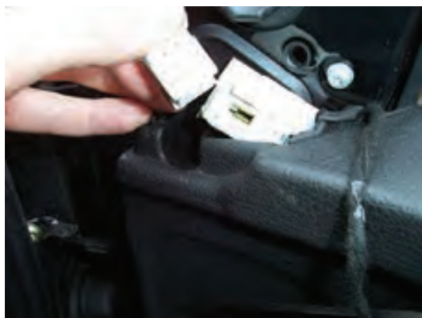
شکل ۱۶۶-۲- جدا کردن سوکت سیم کشی آینه
