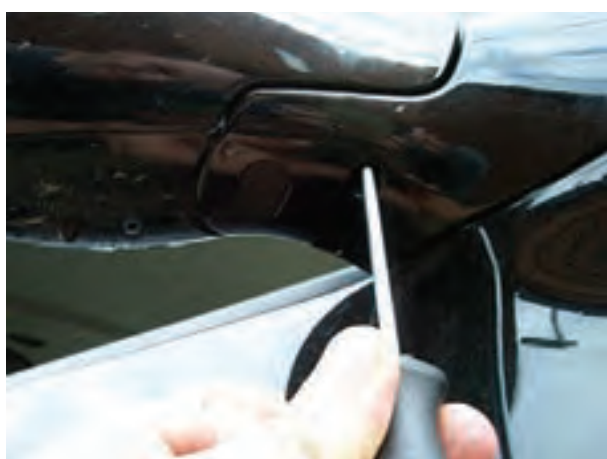
شکل ۱۷۶-۲ بازکردن پیچ روی پایه ی بیرونی آینه
