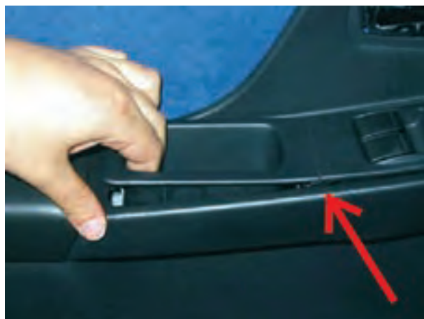
شکل ۲-۱۸۳ خارج نمودن قاب سوئیچ‌ها
