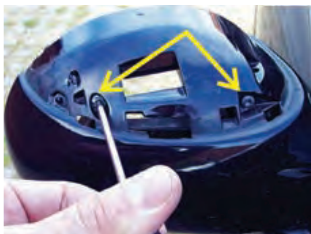
شکل ۱۷۴-۲- باز کردن پیچ‌های قاب بیرونی آینه
