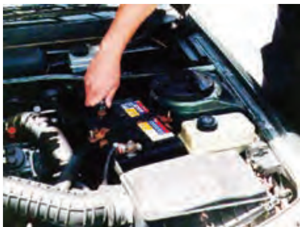
شکل ۱۶۴-۲ بازکردن کابل اتصال بدنه‌ی باتری
