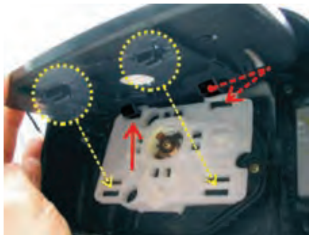
شکل ۱۶۲-۲ زائده‌ها و خارهای اتصال آیین به صفحه‌ی زیرین
