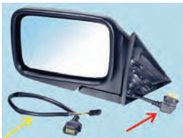
شکل ۱۵۷-۲- آینه‌ی الکتریکی خودرو
