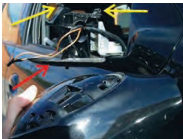
شکل ۱۷۷-۲ شاسی آینه ی جانبی و قاب بیرونی آینه پس از پیاده کردن آن
