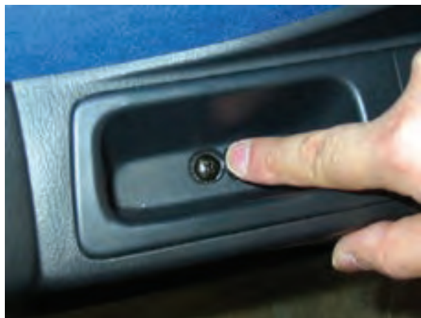
شکل ۲-۱۸۲ پیچ اتصال قاب سوئیچ به بدنه
