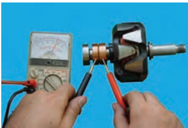
شکل ۷۵-۷- آزمایش سالم بودن سیم پیچ روتور
