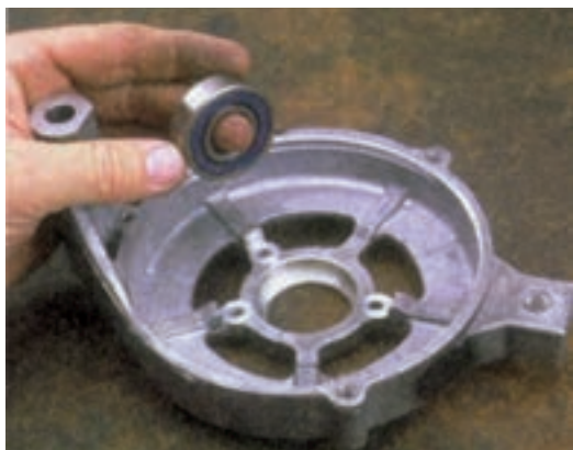
شکل ۷۰-۷ - خارج کردن بلبرینگ و آزمایش آن
