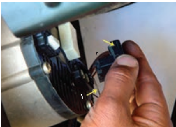
شکل ۵۰-۷ جدا کردن خار و مغزی اتصال سیم از آلترناتور ۱- خار ۲- مغزی اتصال سیم
