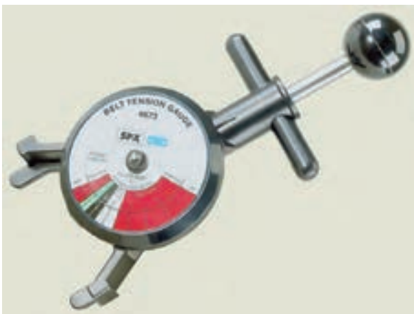
شکل ۸۸-۷- دستگاه اندازه‌گیر کشش تسمه
