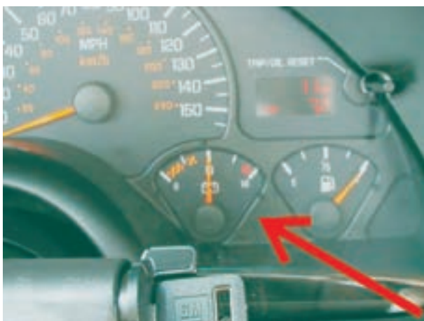
شکل ۷-۹۰- بررسی شارژ آلترناتور با نشان دهنده ی روی پانل جلوی راننده
