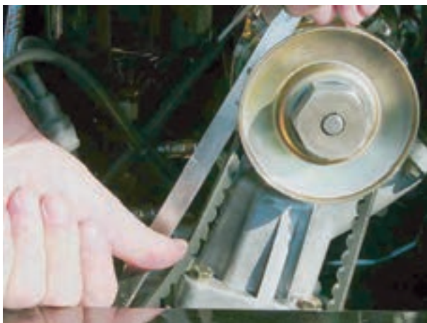
شکل ۷-۸۹- اندازه گیری خلاصی تسمه پروانه
