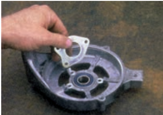
شکل ۶۸-۷ - در آوردن نگه‌دارنده‌ی بلبرینگ
