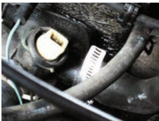
شکل ۶-۲۵- ترمینال‌های سنسور حرارتی مدار خنک‌کاری
