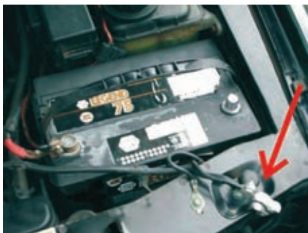
شکل ۱۵-۶- جدا کردن بست کابل اتصال بدنه‌ی باتری
