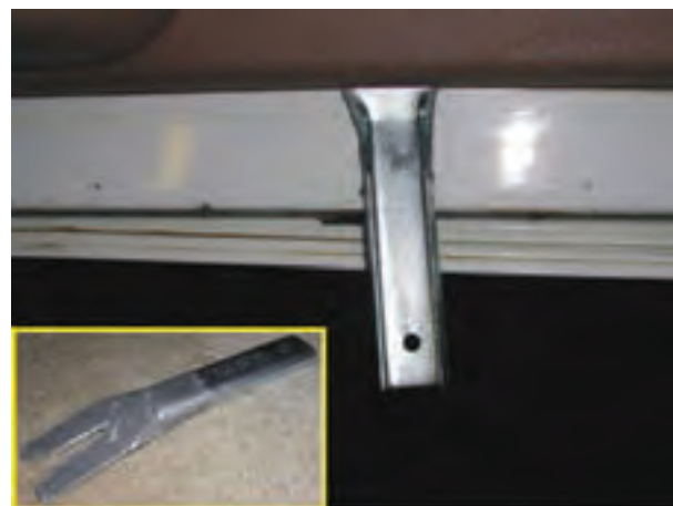
شکل ۲-۳۵- اهرم خاردرآر و نحوه‌ی استفاده از آن
