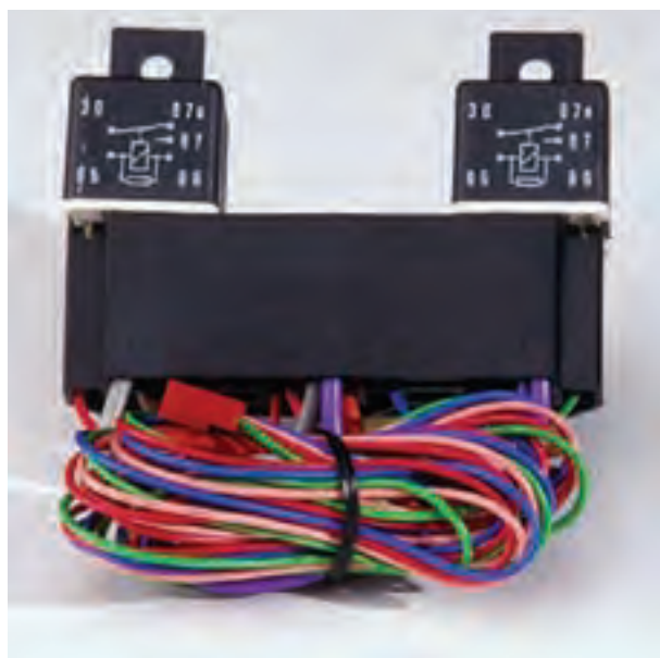
شکل ۲-۴۴- رله‌های مدار الکتریکی قفل مرکزی
