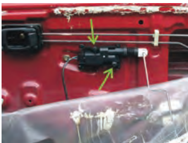
شکل ۲-۲۹ – اتصال عملگر الکتریکی در روی در خودرو
