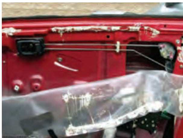
شکل ۲۶-۲- جدا کردن پلاستیک محافظ روی در
