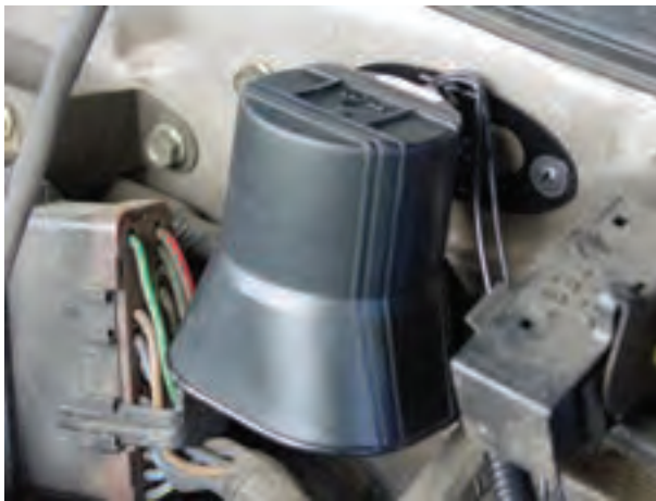
شکل ۵۸-۲- یک نوع آژیر سیستم دزدگیر خودرو
