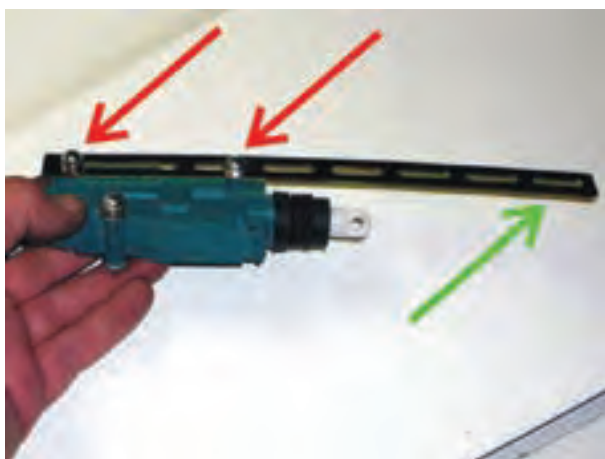
شکل ۴۱-۲- بست فلزی و پیچ‌های اتصال بست به عملگر الکتریکی در خودرو
