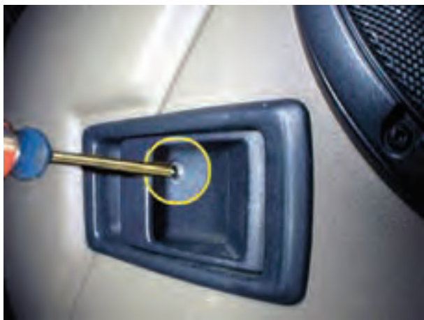
شکل ۳۶-۲- باز کردن قاب دستگیره‌ی قفل در
