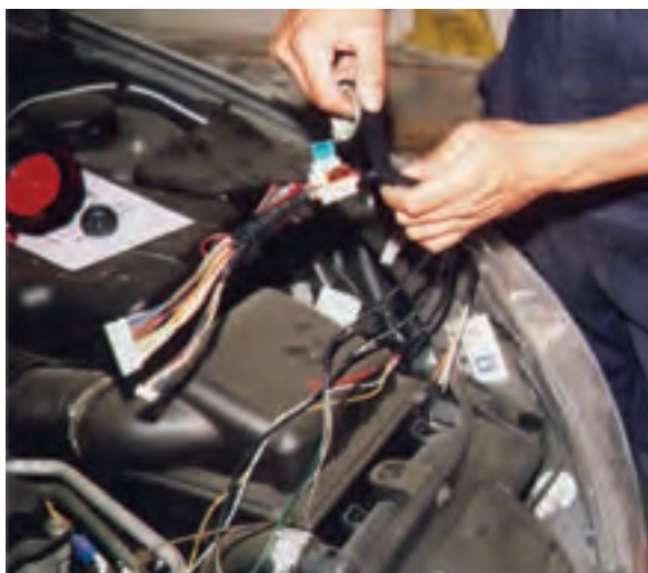
شکل ۲-۷۷- نحوه‌ی عایق‌بندی سیم‌های مدار الکتریکی دزدگیر
