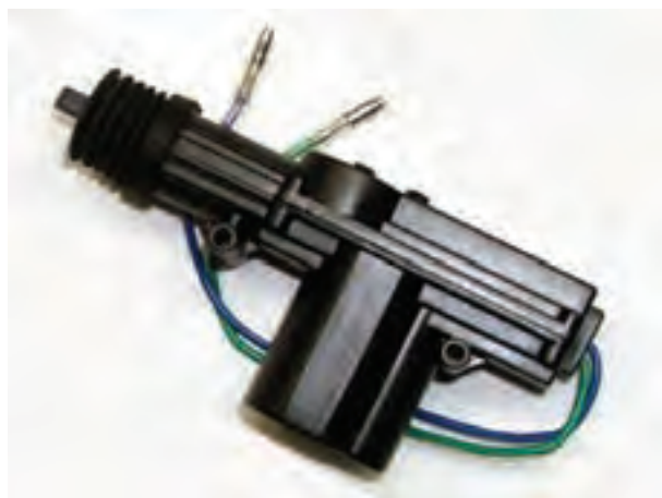
شکل ۲۵-۲- عملگر الکتریکی دو سیمی
