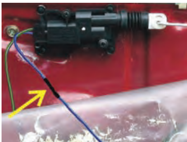
شکل ۲-۴۹- عایق کاری محل اتصال سیم‌ها به یکدیگر
