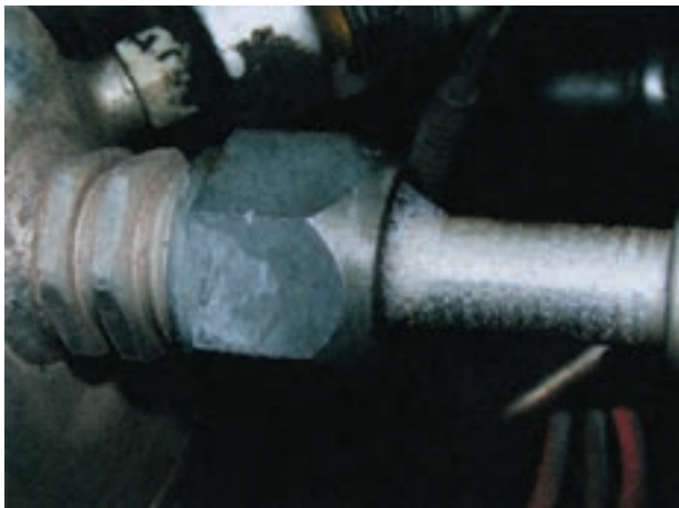
شکل ۲۹-۵- آزمایش نشت گاز
