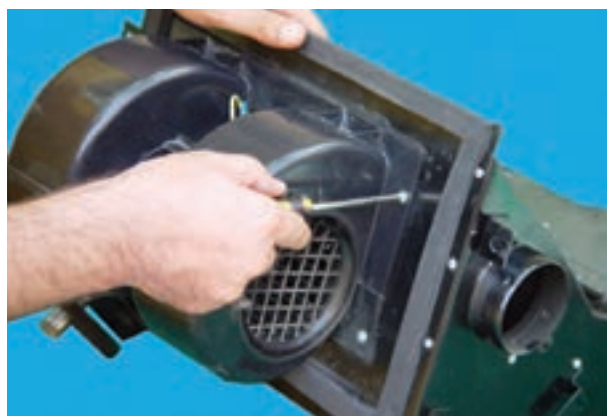
شکل ۴-۳۶- باز کردن پیچ‌های محفظه‌ی موتور
