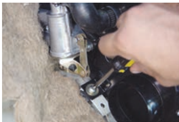
شکل ۴-۳۳- پیچ‌های پایه‌ی بخاری
