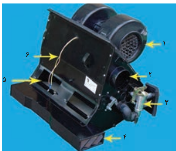
شکل ۴-۳۴- خارج کردن بخاری از محل نصب آب
