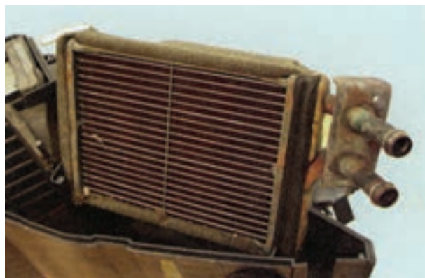
شکل ۳۰-۴ رادیاتور بخاری
