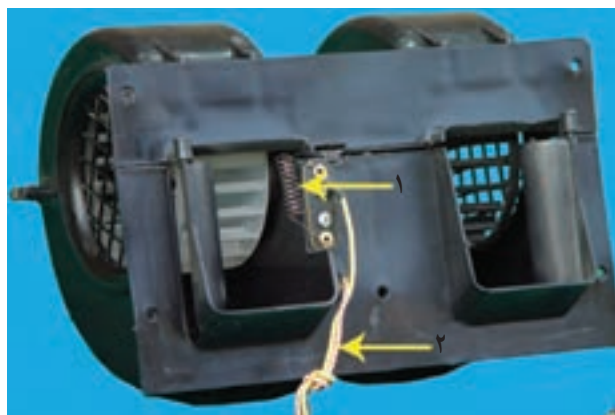
۱- مقاومت ۲- سیم های اتصال مقاومت
