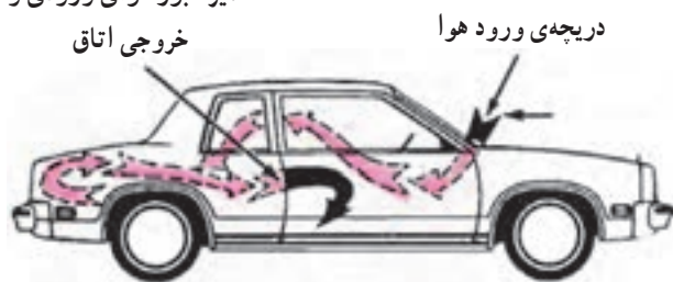
شکل ۴-۱۱- مسیر عبور جریان هوای گرم در خودرو
