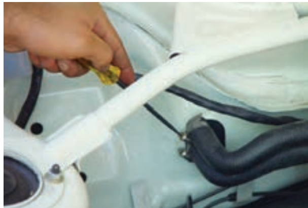
شکل ۴-۳۱- باز کردن لوله‌های آب رادیاتور بخاری
