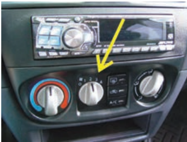
شکل ۴-۵۲- سوئیچ فن چهار وضعیتی
