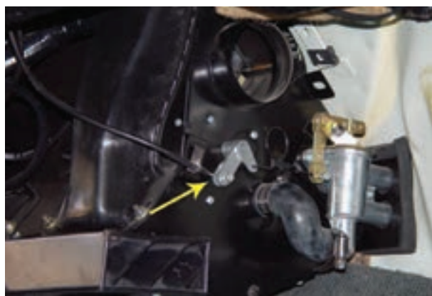
شکل ۴-۳۲- اتصالات دریچه‌ی بخاری
