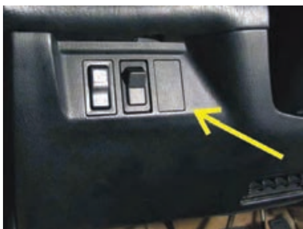
شکل ۳-۱۳- محل نصب سوئیچ در روی پانل جلوی راننده
