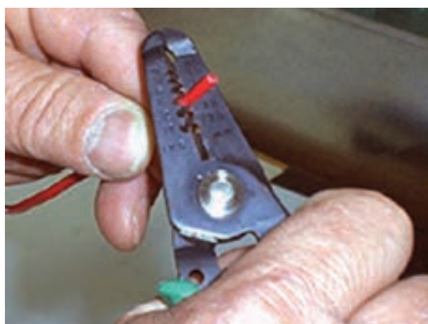
شکل ۳-۳۸- جدا کردن عایق سر سیم‌ها
