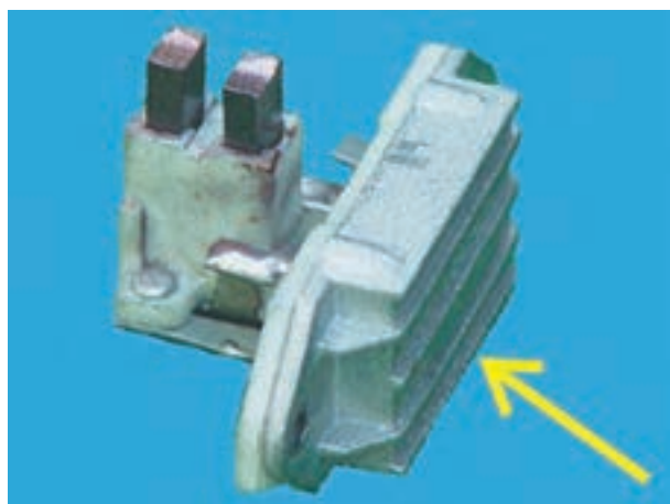
شکل ۳-۶ آفامات یا رگلاتور
