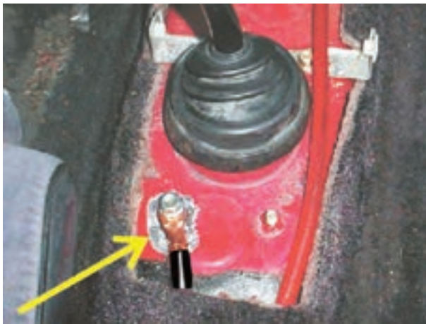
شکل ۲-۲۵- اتصال بدنه‌ی باتری در داخل اتاق خودرو
