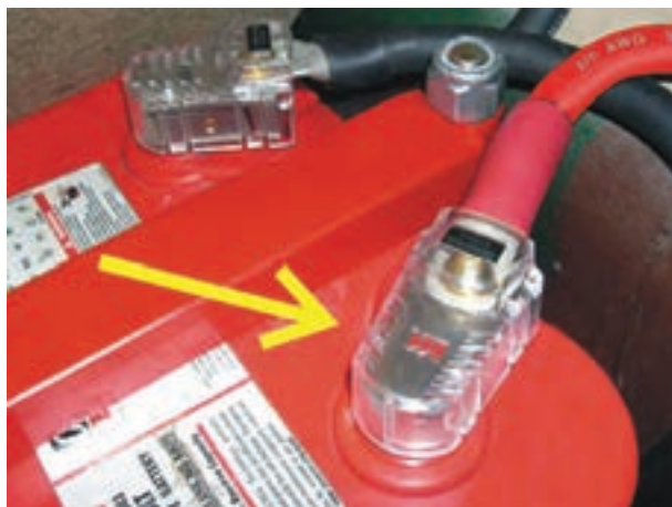
شکل ۱۹-۲- مورد استفاده تلق محافظ قطب‌های باتری
