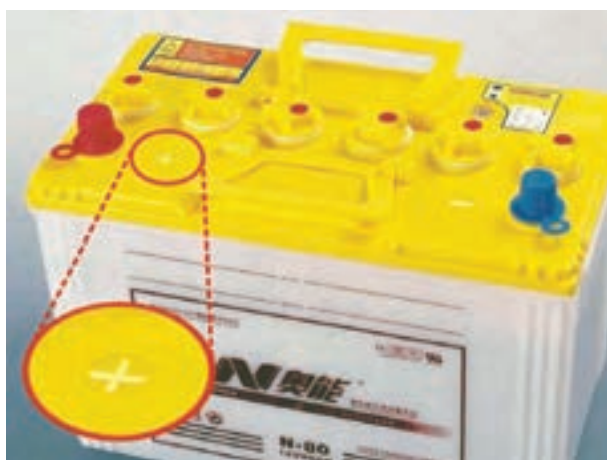
شکل ۲-۹- کاربرد علائم برای تشخیص قطب‌های باتری
