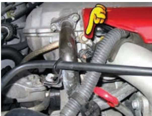
شکل ۲-۲۶- محل اتصال کابل منفی باتری به بدنه‌ی موتور
