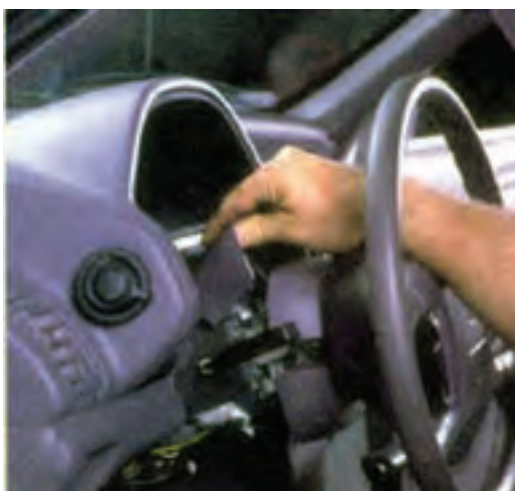
شکل ۹۱-۱- بیرون آوردن قاب سوئیچ روشنایی
