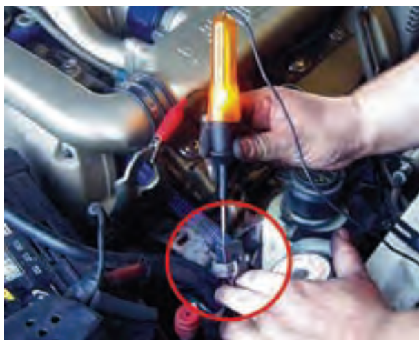
شکل ۱-۱۴۵- آزمایش برقراری جریان مدار چراغ های روشنایی
