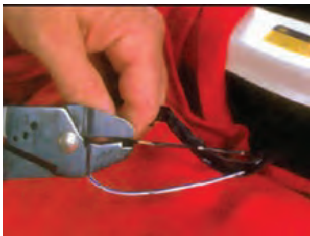
شکل ۱۴۶-۱- استفاده از انبر مخصوص برای قطع سیم
