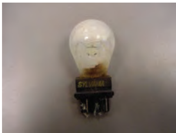
شکل ۱۴۱-۱- اثر عوامل فیزیکی در معیوب شدن لامپ
