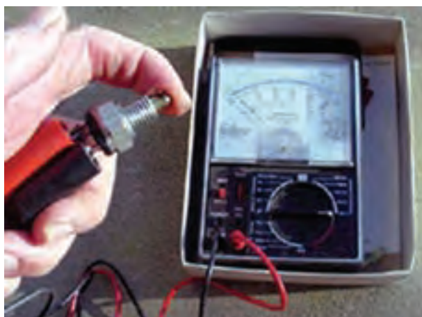
شکل ۱۰۵-۱- آزمایش سوئیچ چراغ‌های دنده عقب
