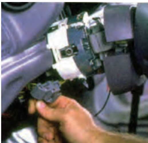
شکل ۹۴-۱- جدا کردن سوکت اتصال الکتریکی
