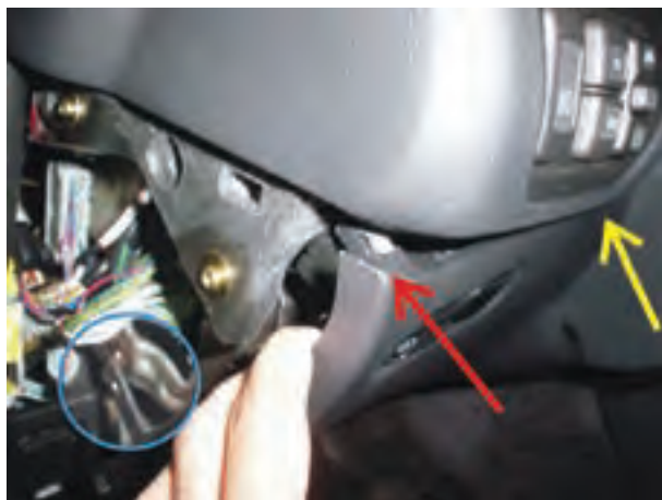
شکل ۱-۸۵- خارج کردن قاب از روی بدنه‌ی پانل
