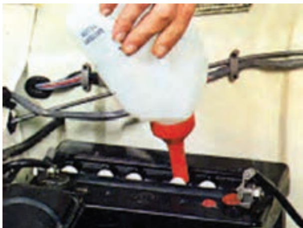
شکل ۱-۷۴- کنترل سطح الکترولیت
