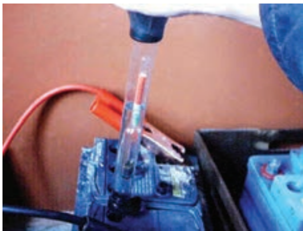
شکل ۱-۵۳- کنترل غلظت الکترولیت
