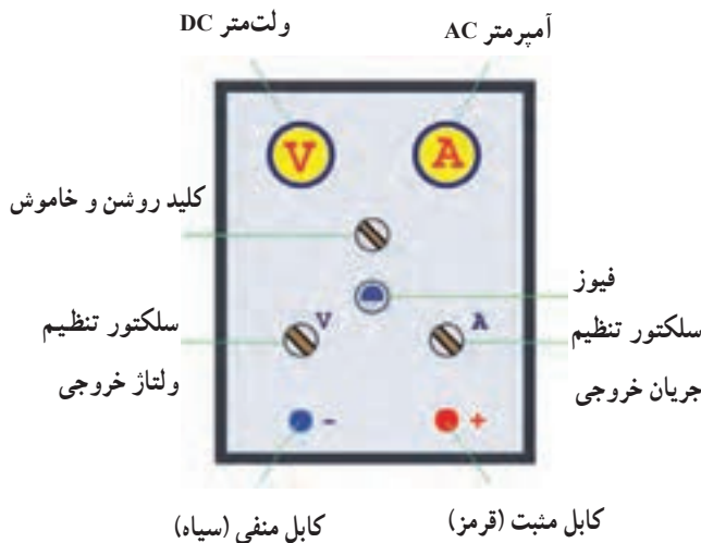
شکل ۴۶-۱- اجزای دستگاه شارژ باتری
