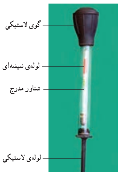
شکل ۱-۱۴- دو نوع هیدرومتر یا چگالی سنج
