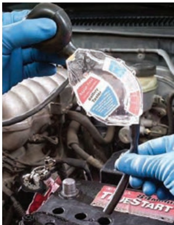
شکل ۱-۶۴- آزمایش چگالی الکترولیت داخل خانه‌های باتری
