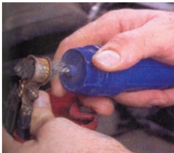
شکل ۹۱-۱ - پاک کردن بست‌های باتری با برس سیمی
