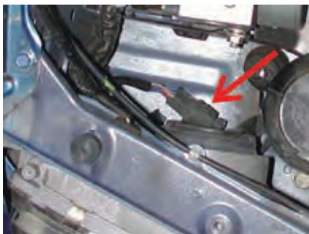
شکل ۳۷-۱- کائوچویی اتصال سیم‌کشی چراغ‌های روشنایی
