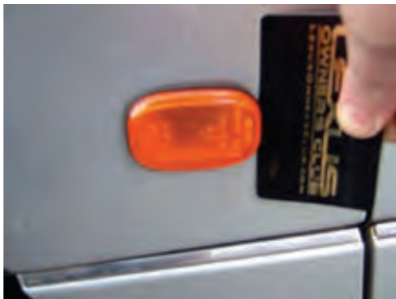
شکل ۱-۶۶- نحوه‌ی بیرون آوردن چراغ راهنمای بغل یک نوع خودرو
