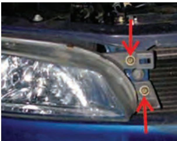
شکل ۱-۴۰- پیچ‌های نگه‌دارنده‌ی چراغ‌های بزرگ جلو
