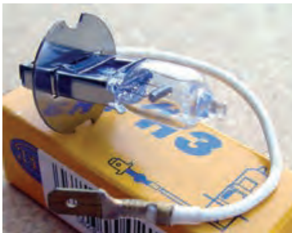
شکل ۱-۳۱- لامپ مورد استفاده در چراغ‌های مه‌شکن، نورافکن‌ها
