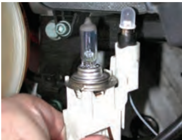
شکل ۱-۴۹ - پایه‌ی مشترک لامپ‌های چراغ روشنایی و پارک
