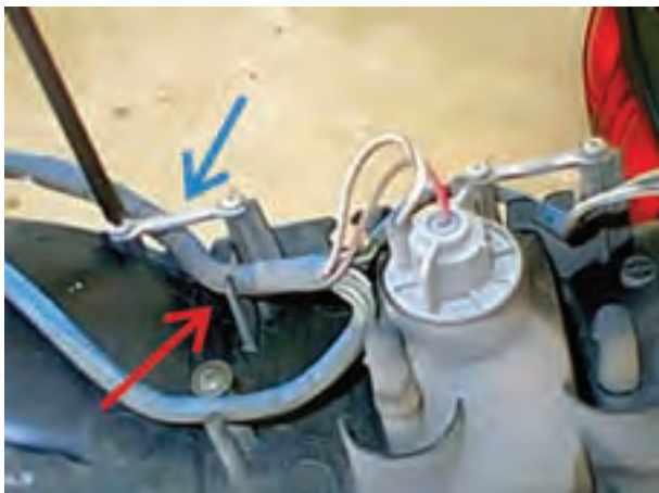
شکل ۱-۶۱- خار پلاستیکی و پل طراحی شده در قاب چراغ‌ها
