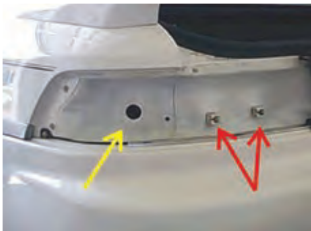
شکل ۱-۵۹- محل عبور دسته‌ی سیم لامپ‌ها و محل اتصال خارها در بدنه‌ی خودرو
