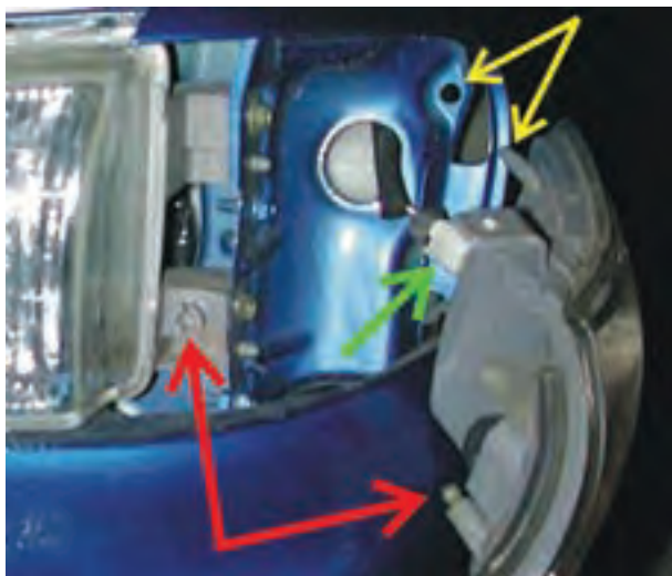
شکل ۱-۳۹- خارهای روی بدنه‌ی چراغ جانبی جلو و محل نصب آن‌ها
