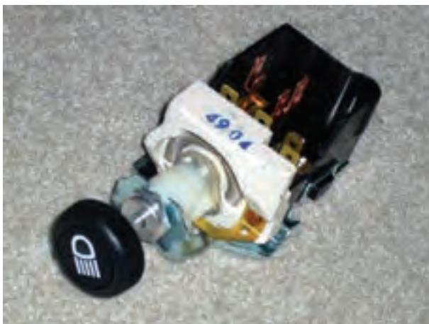
شکل ۱-۷۱- سوئیچ چراغ‌های روشنایی نوع چرخشی
