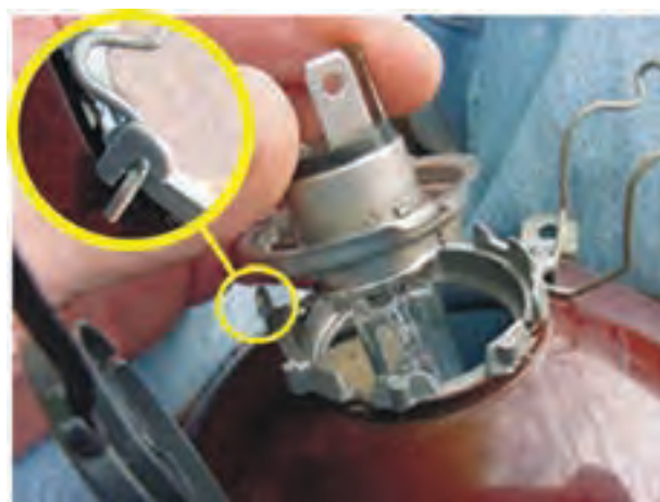
شکل ۱-۴۳- نحوه‌ی ثابت شدن لامپ درون کاسه‌ی چراغ
