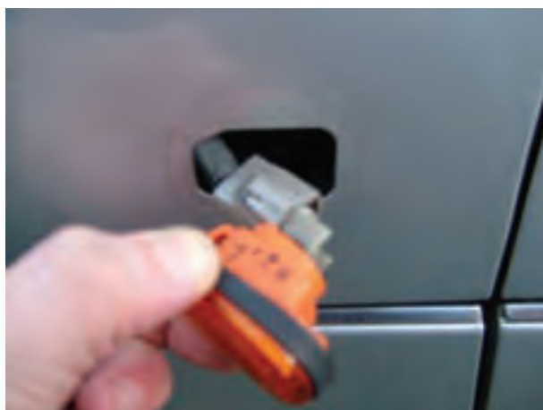
شکل ۱-۶۷- خارج کردن چراغ راهنمای بغل از محل خود در روی بدنه‌ی خودرو
