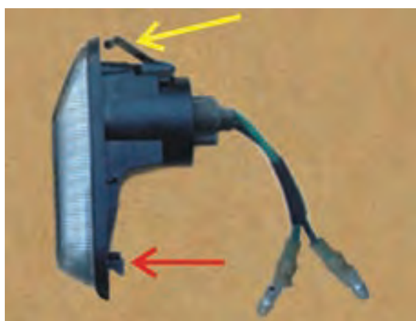
شکل ۱-۶۸- خار و فنر روی کاسه‌ی چراغ
