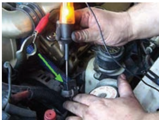
شکل ۱-۷۳- آزمایش سیم کشی مدار
