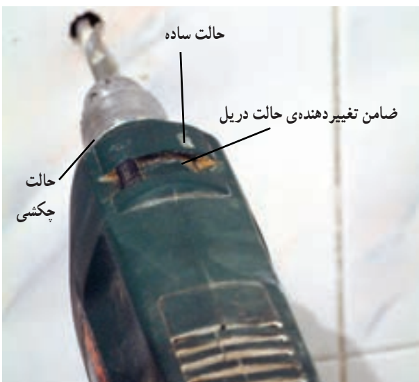
شکل ۲۱-۳ سوراخ کردن محل علامت‌گذاری شده
