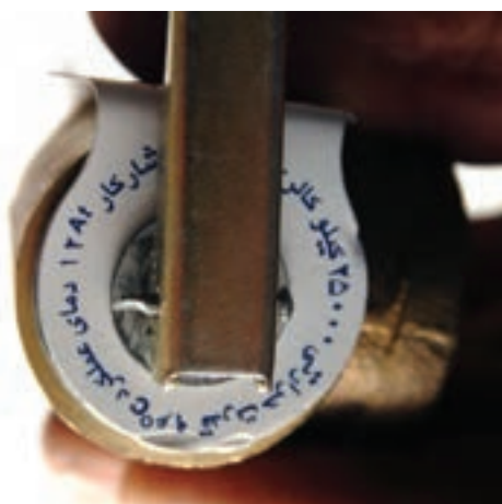
شکل ۲-۱۰۸- شیر اطمینان فشاری و حرارتی
