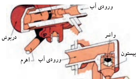
شکل ۱۱۳-۲ اجزای شیر شناور
