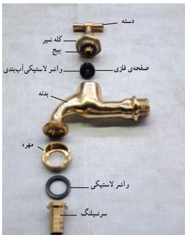
شکل ۱۲-۲- ب - اجزای شیر برنجی سرشیلنگی
