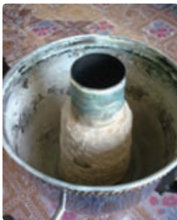
شکل ۸-۵- تشکیل رسوب در سماور و لوله‌ها
