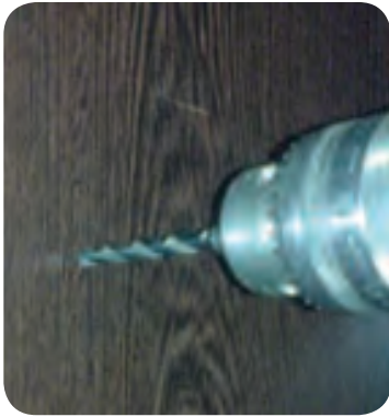
شکل ۱-۶- سوراخکاری دکور با مته چوب یا آهن
