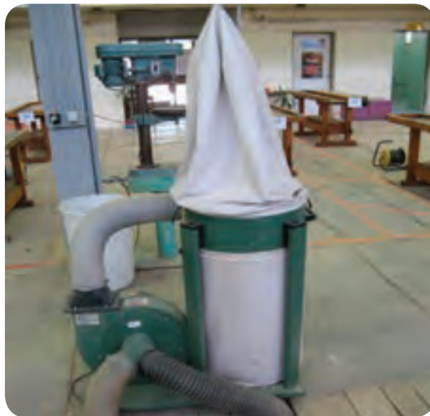
شکل ۲۴-۵- خروج ضایعات از طریق کانال پوشیده شده
