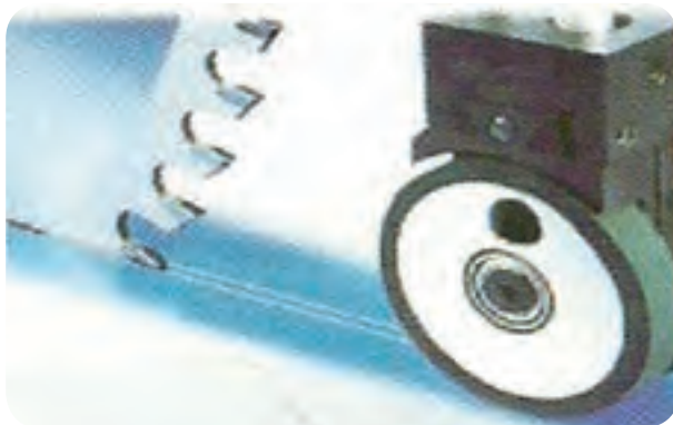
شکل ۳۸-۵- تیغه خطزن مخصوص
