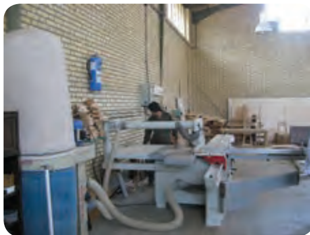
شکل ۵-۵۹- مکنده مناسب ماشین دورکن
