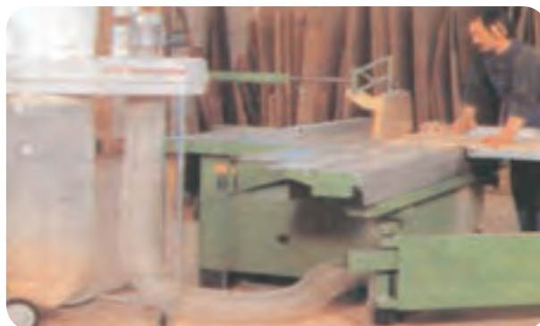
شکل ۲۵-۵- استفاده از حفاظ و تجهیزات ایمنی
