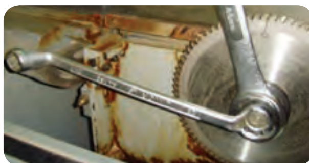
شکل ۵-۵۶- نحوه باز و بسته کردن تیغه اره
