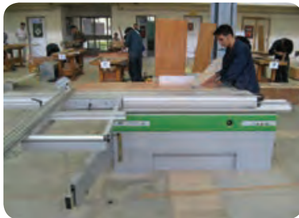
شکل ۱۱۵-۵- برشکاری قطعات سقف و کف
