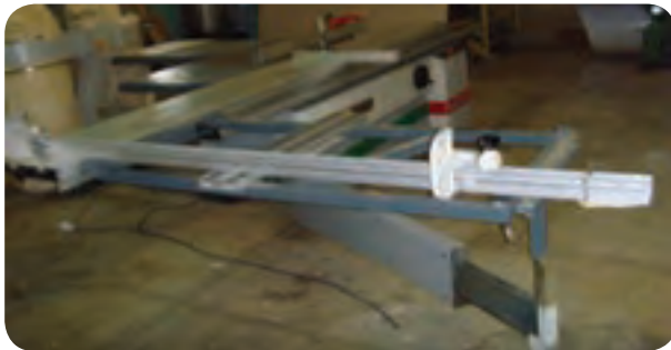
شکل ۵-۴۹- میله کشویی جلوی میز متحرک برای برش صفحات بزرگ
