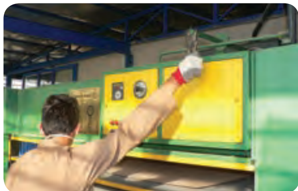
شکل ۹۵-۵- اهرم باز کردن صفحات پرس
