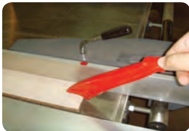
شکل ۵-۶۵- استفاده از وسیله کمکی هدایت قطعه باریک
