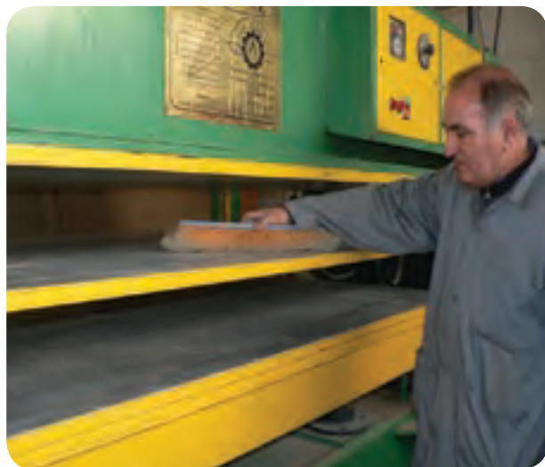
شکل ۵-۹۸- تمیز کردن پرس در پایان کار
