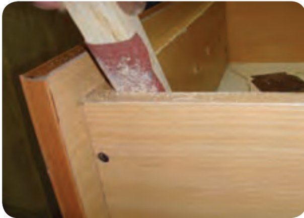
شکل ۱۸۲-۵- برطرف کردن لبه تیز صفحات با سوهان
