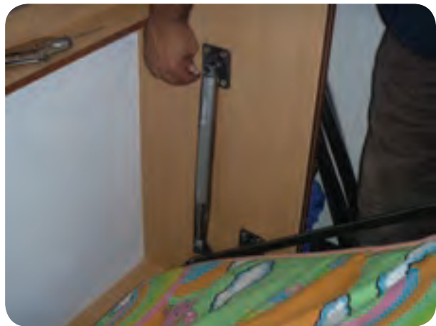
شکل ۵-۱۳۷ تنظیم فشار گاز سیلندر برای تعادل تختخواب
