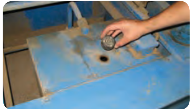
شکل ۸۸-۵- کنترل و تعویض روغن هیدرولیک مخزن
