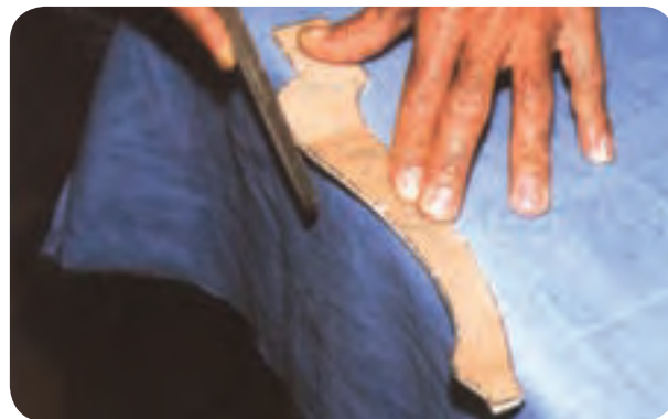
شکل ۵-۲۱- تهیه شابلن خط‌کشی برای ساخت پایه
