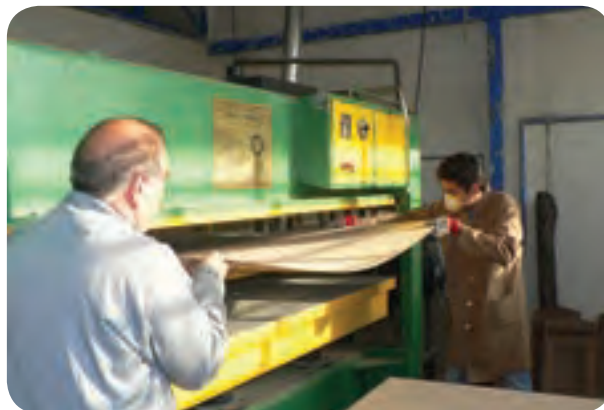
شکل ۵-۹۶- خارج کردن صفحات پرس شده
