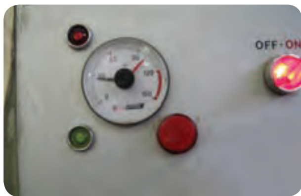
شکل ۸۶-۵: چراغ کنار حرارت‌سنج
