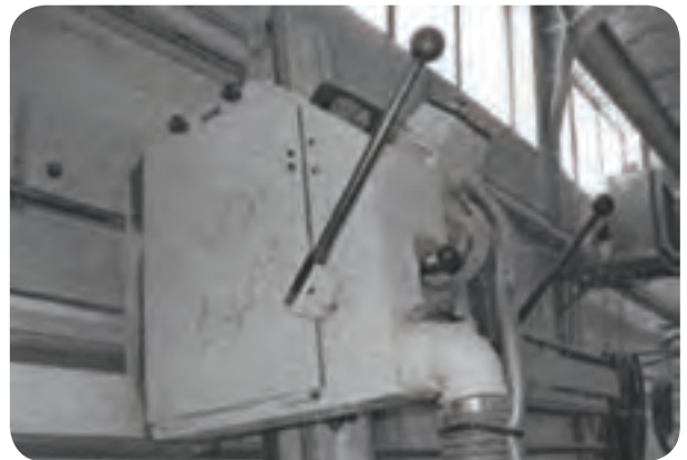
شکل ۳۹-۵- اهرم حرکت اره برای برش
