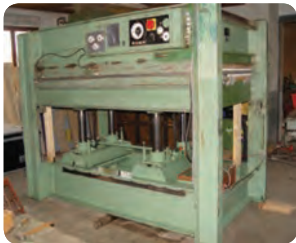
شکل ۷۴-۵ پرس گرم الممتی دو طبقه هیدرولیکی
