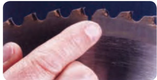
شکل ۴۲-۵- دندانه‌های اره شکسته یا کند شده
