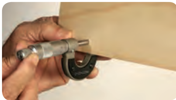
شکل ۷۲-۵ اندازه‌گیری ضخامت روکش با میکرومتر
