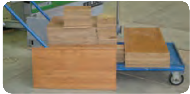
شکل ۴۱-۵- حمل صفحات بریده شده کوچک با گاری
