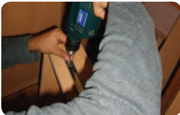
شکل ۱۷۶-۵- نصب ریل تکی به بدنه کشو
