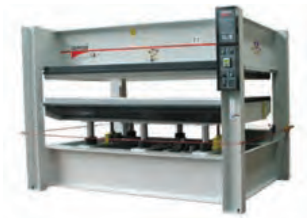
شکل ۵-۹۷- بندهای قطع اضطراری برق پرس در اطراف آن
