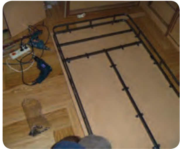
شکل ۱۳۰-۵- استقرار کلاف فلزی روی صفحه جلو تختخواب
