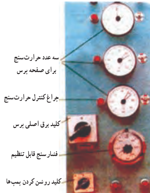
شکل ۸۷-۵- تنظیم اجزای پرس برای چسباندن روکش
