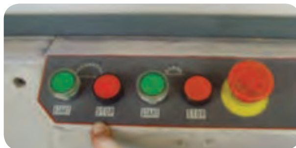
شکل ۵-۶۰- کلید خاموش و روشن کردن ماشین دورکن
