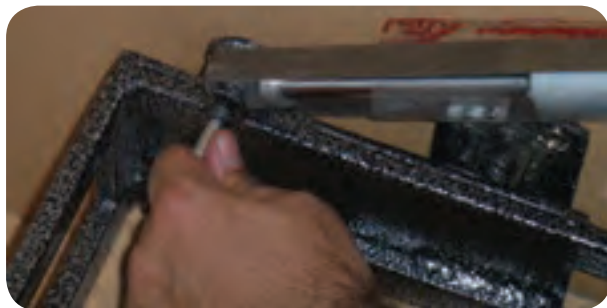
شکل ۵-۱۳۶ محکم کردن پایه‌های جک‌های تختخواب
