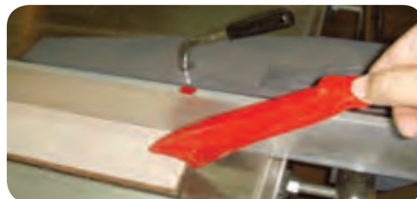
شکل ۱۰۵-۵- هدایت قطعه باریک به وسیله کمکی
