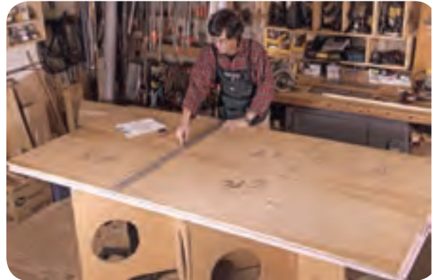
شکل ۵-۴۷- خط‌کشی صفحه‌ام‌دی‌اف برای برش
