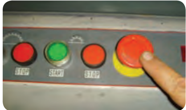
شکل ۵-۶۷- کلید خاموش کردن کلی ماشین دور کن
