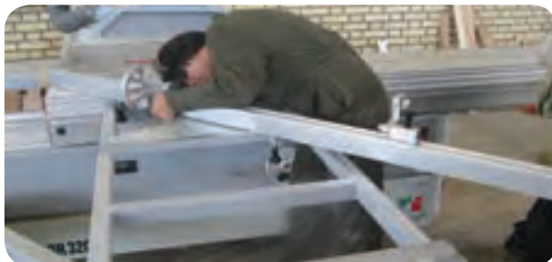
شکل ۵-۵۰- تنظیم دو کفشک کنترل اندازه‌گیری
