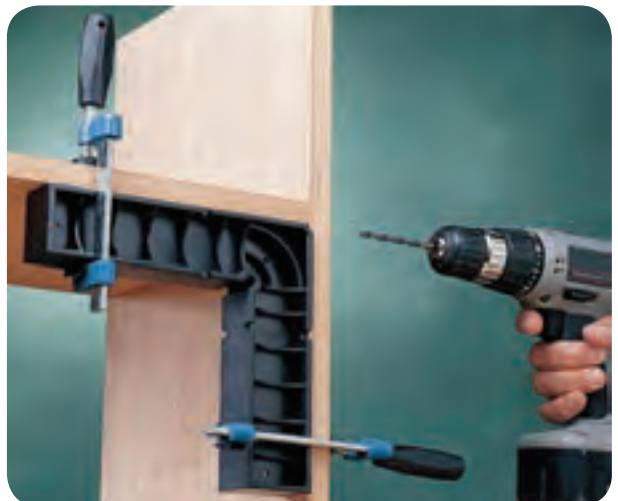
شکل ۱۷۰-۵- استفاده از شابلون برای جلوگیری از دوئیدگی
