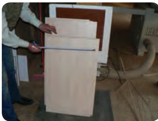
شکل ۱۱۶-۵- کنترل اندازه قطعات آماده شده
