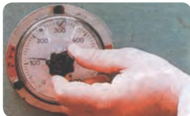
شکل ۷۹-۵ تنظیم فشارسنج پرس
