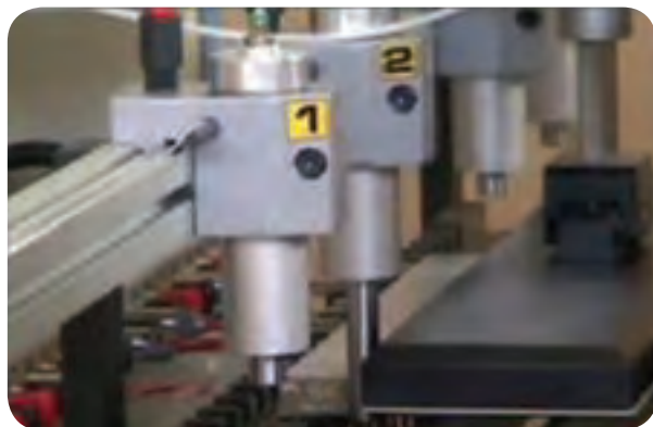
شکل ۳-۷ - قطعه کار، توسط جک‌ها گونیا شده است.
