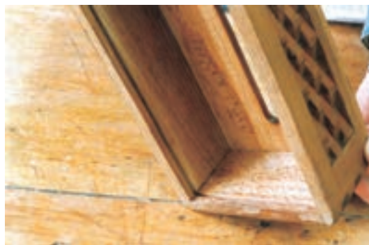
شکل ۹-۶۷- کنشکاف داخل بدنه‌های یک جعبه دستمال کاغذی.
