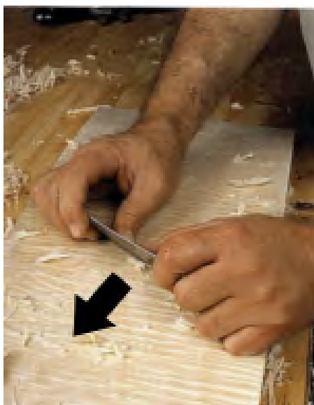
شکل ۲۸-۲. نمونه ی گرفتن لیسه با شست دست و هدایت آن.
