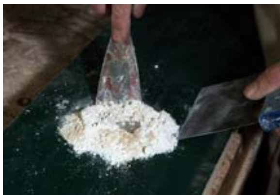
شکل ۴-۱۴- چگونگی کار کردن با کاردک و لیسه.
