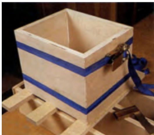
شکل ۱-۴۸- از گیره‌ی تسمه‌ای می‌توان برای چسباندن بدنه‌های صندوق مکعبی نیز استفاده کرد. با توجه به ارتفاع آن، می‌توان ۲ تسمه یا بیشتر به‌کار برد.
