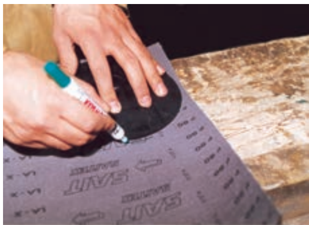
شکل ۷-۳۵- ترسیم گردی دیسک (روی سنباده).
