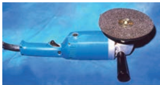
شکل ۷-۱۴- دستگاه سنباده دیسکی (ماشین پوست).
