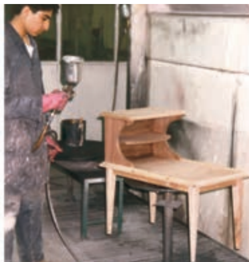
شکل ۲۴-۴. رنگ‌کاری با پیستوله (رنگ شفاف).
