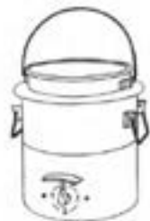
شکل ۱-۳. ظرف سریشم الکتریکی با جای آب از ورق مس.
