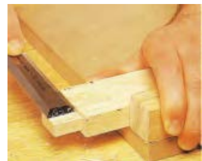
شکل ۹-۹۸- اندازه کردن زبانه با مغار.
