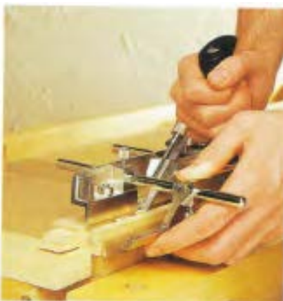
شکل ۹-۱۰۰- شیار انداختن دافل قیدهای عرضی.
