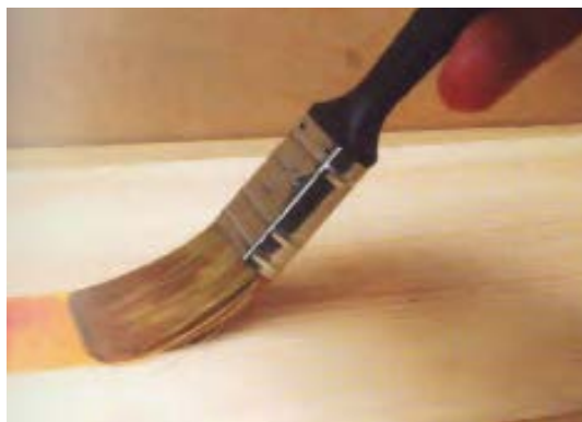
شکل ۴-۴۳- قلم مو را در جهت الیاف چوب بکشید.
