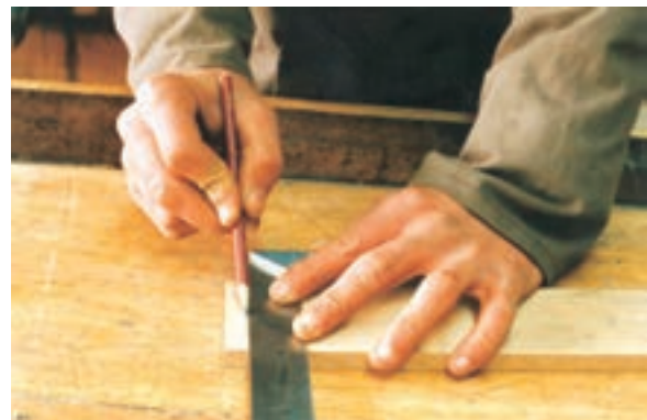
شکل ۹-۶۳. فم کشی ممل اتصال با گونیا.
