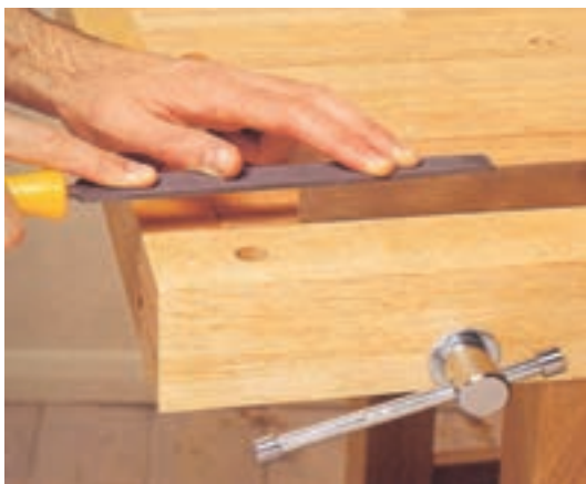
شکل ۲-۷. نمونه‌ی سوهان زدن ضخامت لیسه.
