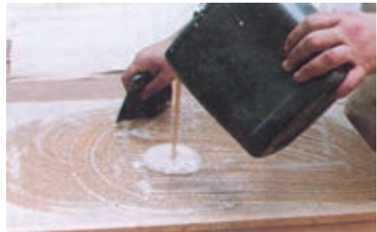
شکل ۶-۴. پخش کردن چسب به وسیله‌ی شانه‌ی چسب‌زنی.
