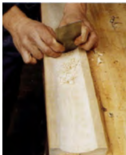
شکل ۲-۵. کاربرد لیسه با لبه‌ی نیم گرد.
