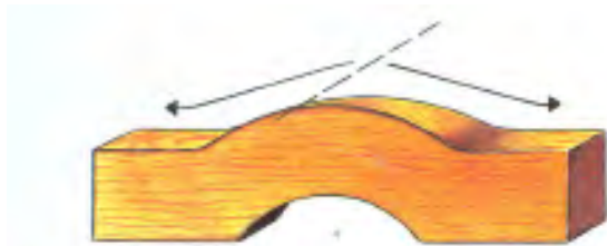
شکل ۲-۳۳. رندیدن در جهت الیاف.
