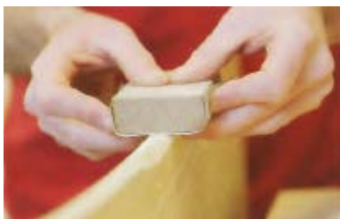
شکل ۳-۲۱. طریقه‌ی سنباده‌کاری نر قطعات با دو دست.
