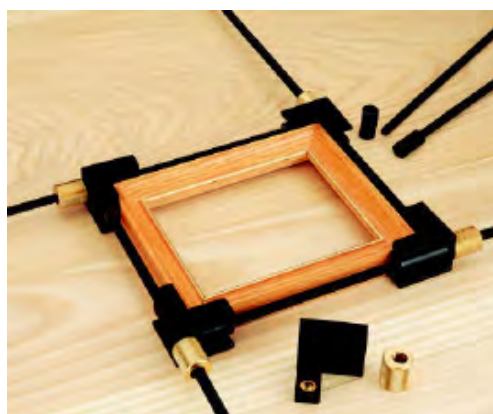
شکل ۱-۳۹. برای چسباندن قاب‌ها، باید از گیره‌هایی استفاده کرد که دارای فک‌های ۹۰ درجه است.
