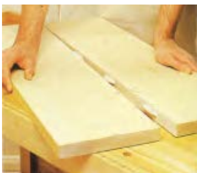
شکل ۹-۹۴- صفحه‌ی (ویه، با اتصال بیسکوییتی.
