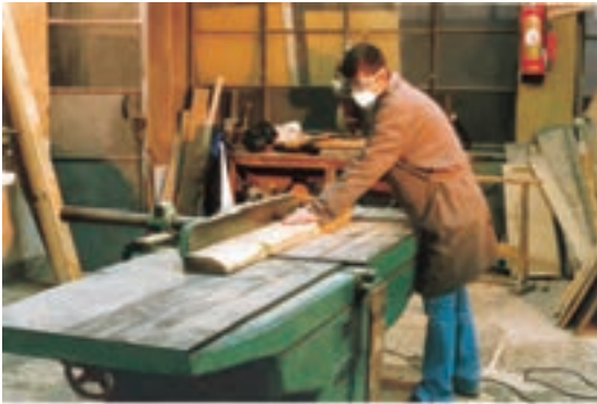
شکل ۹-۹- مقدار باز بودن زیاد گونیا، فطرآفرین است.
