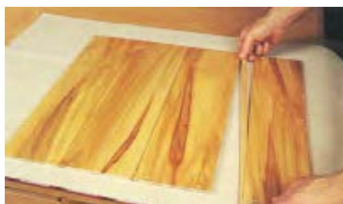
شکل ۵-۲۶- جور کردن (روکش‌ها)
