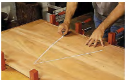
شکل ۱-۴۷- تفت‌های درز شده را باید کنار هم (روی تنگ‌ها) قرار داد و علامت مثلث ( \Delta ) را روی آن ترسیم کرد؛ سپس باید آنها را چسب زد، در جای خود قرار داد و تنگ‌ها را ممکن نمود.
