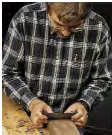
شکل ۲-۳۰. پرداخت سطوح قوس دار به وسیله لیسه.
