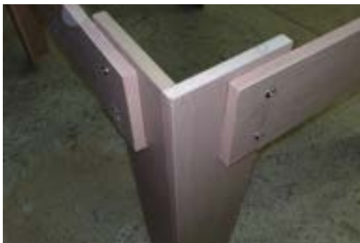
شکل ۱۲-۱۶- اتصال پایه به قید توسط پیچ فیکس.
