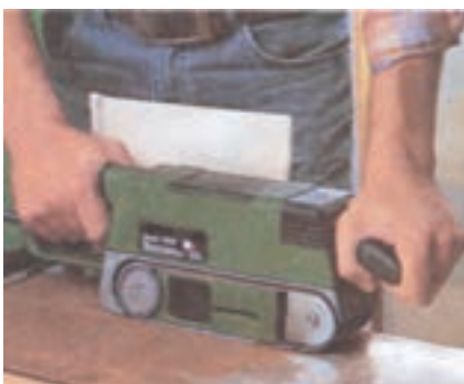
شکل ۷-۴. روش کنترل و کاربرد صمیع دستگاه.
