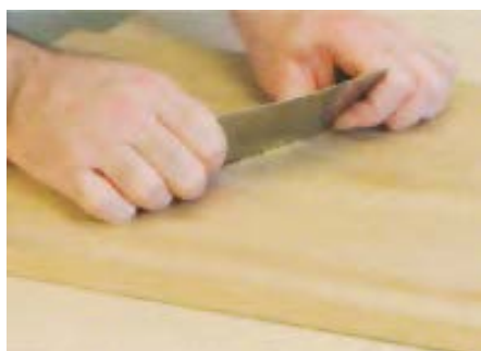
شکل ۲-۱۳- جهت حرکت لیسه، هنگام پُرزگیری.
