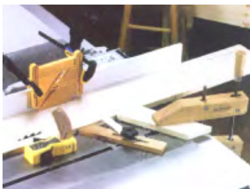
شکل ۱-۲۵- کاربرد گیره‌ی موازی چوبی، برای بستن قطعات به صفحه‌ی ماشین اَره گرد.
