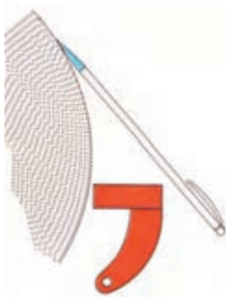
تیز کردن سوزن خط کش
