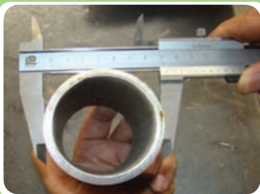
اندازه‌گیری قطر خارجی لوله توسط کولیس
