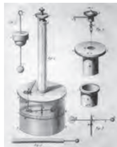
شکل ۲-۱ ترازوی پیچشی کولن. در دو سر یک میله سبک افقی یک کره کوچک و یک قرص قرار دارد. یک کره مشابه از حفره‌ای به داخل برده می‌شود. نیروی مؤثر بین بارها از اندازه‌گیری زاویه چرخش ترازوی پیچشی تارسیدن به تعادل به دست می‌آید. (تصویر از کتاب مرجع سال ۱۷۸۵ م.)
