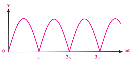
ب - شکل ولتاژ خروجی یکسوکننده تمام موج
