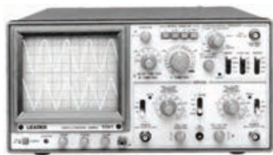
شکل ۶-۳۵ نمایش همزمان دو شکل موج توسط اسیلوسکوپ
