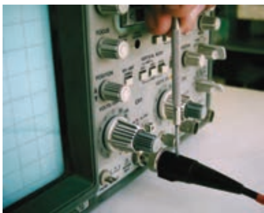
شکل ۸-۶ نحوه‌ی تنظیم پروب
