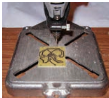
شکل ۷-۸ سوراخ کاری با دریل برقی
