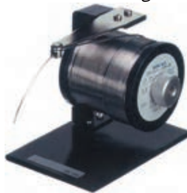
شکل ۳-۳۲- قرقره‌ی لحیم و پایه‌ی نگه‌دارنده‌ی آن
