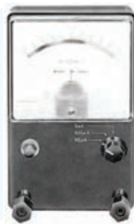
شکل ۲۶-۳- یک نمونه گالوانومتر صفر وسط
