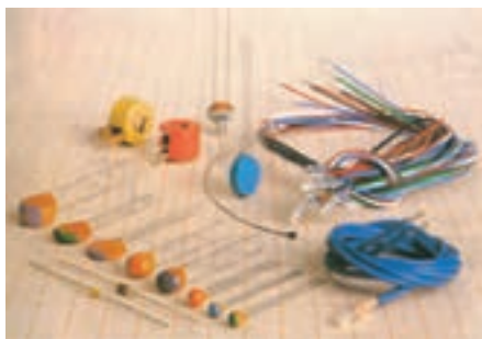
شکل ۱۱-۲ چند نمونه از مقاومت های NTC و علامت اختصاری آن
