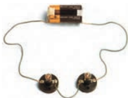
شکل ۲۹-۲ مدار واقعی دو لامپ به صورت سری
