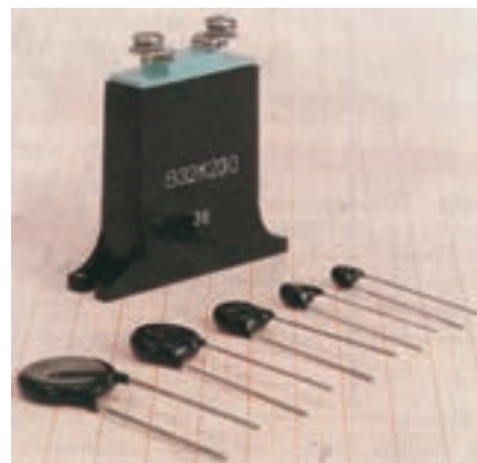
شکل ۱۴-۲ شکل ظاهری واریستور و نماد آن
