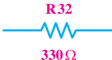
شکل ۱-۲۸ نمایش شماره و مقدار مقاومت روی نماد آن
