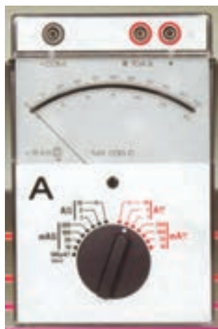
شکل ۱-۴۹ یک نمونه آمپر متر آزمایشگاهی
