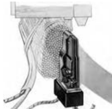
الف) موقعیت اورلود داخلی موتور در داخل سیم بیچ
