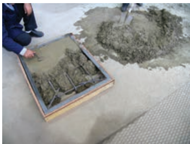
شکل ۶-۱- پرکردن قالب با ملات مناسب
