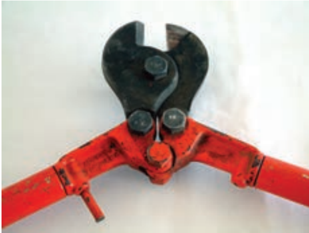
شکل ۵-۷۳- قیچی کابل بری
