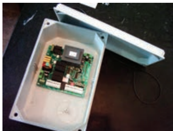
شکل ۱۷-۴ برد الکترونیکی در اتوماتیک لولایی
