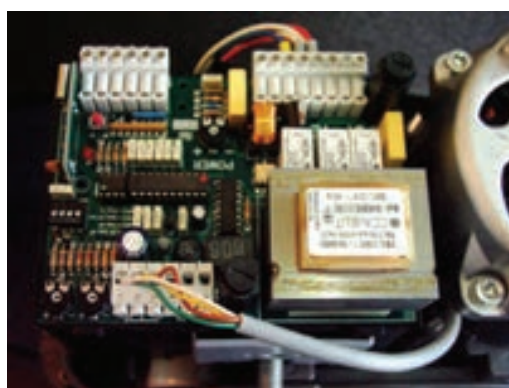
شکل ۱۸-۴ برد الکترونیکی در اتوماتیک ریلی
