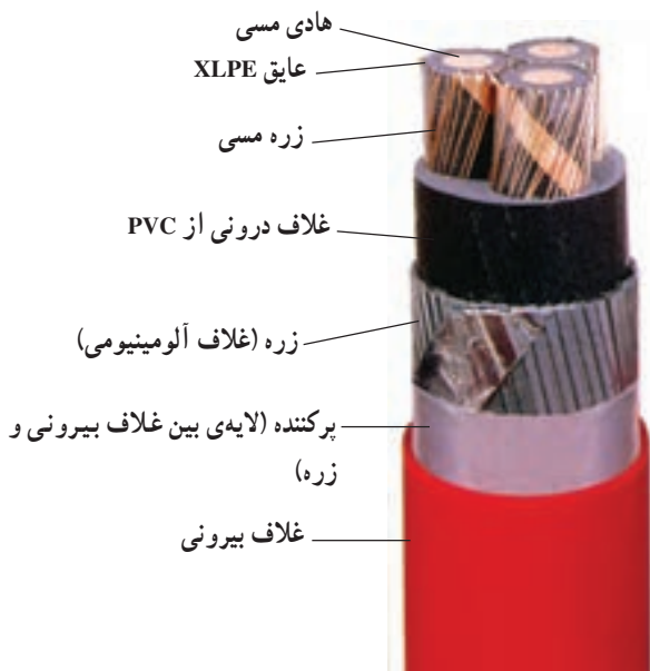
شکل ۵-۷- کابل با غلاف آلومینیومی
