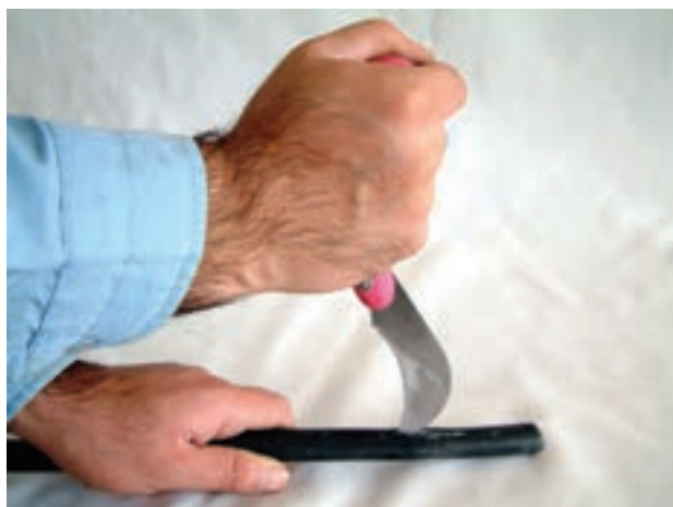
شکل ۳۲-۵ - روکش برداری غلط
