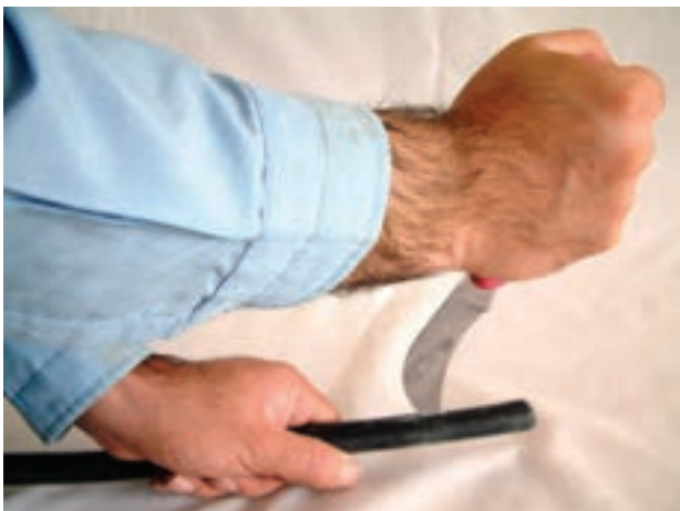
شکل ۳۳-۵- طریقه‌ی صحیح روکش برداری کابل
