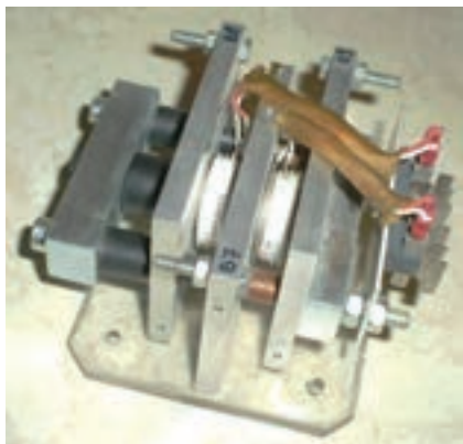
شکل ۳-۳- تریستورهای دیسکی همراه با گرماگیر
